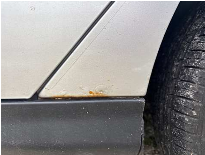
Seitenteil hinten links (Rost, Lackschaden)
