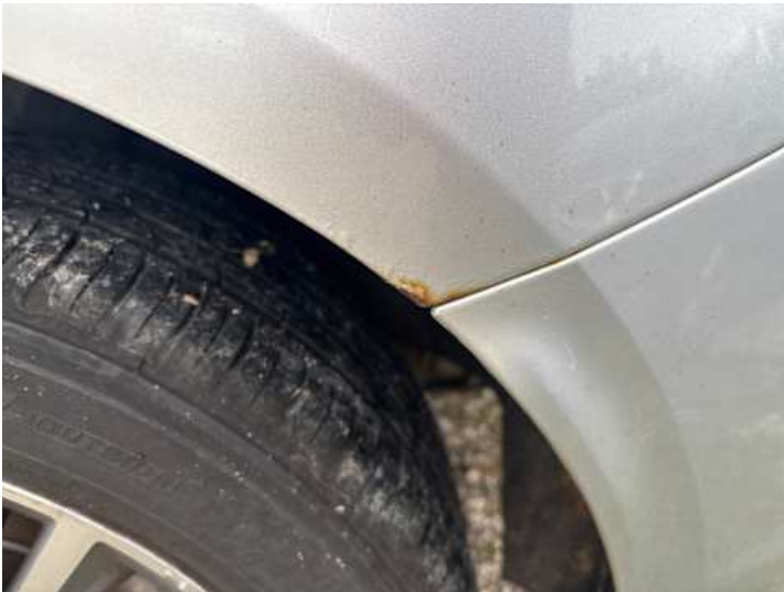
Seitenteil hinten links (Rost, Lackschaden)
