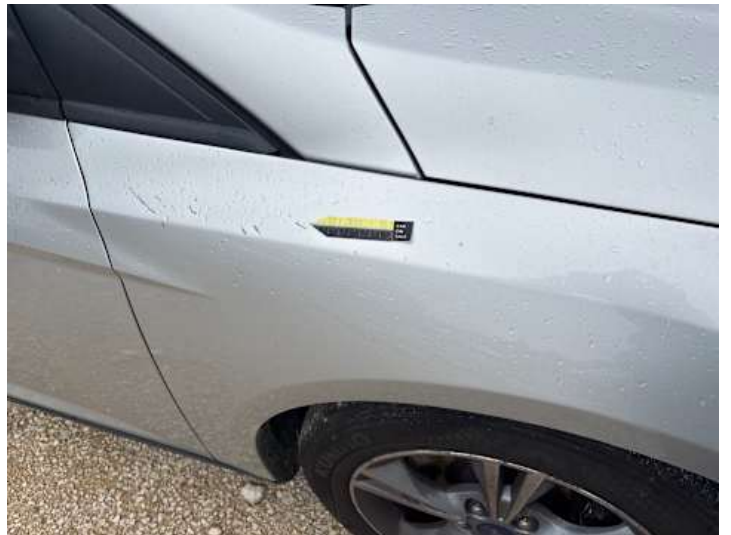
Kotflügel vorne rechts (Kratzer, Lackschaden)
