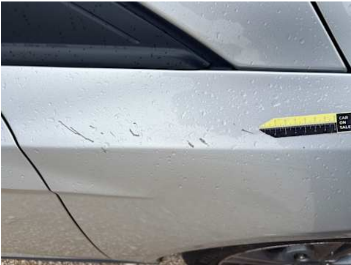
Kotflügel vorne rechts (Kratzer, Lackschaden)
