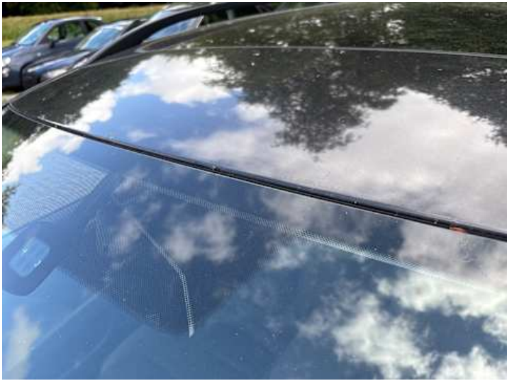
Dach (Rost, Steinschlag)
