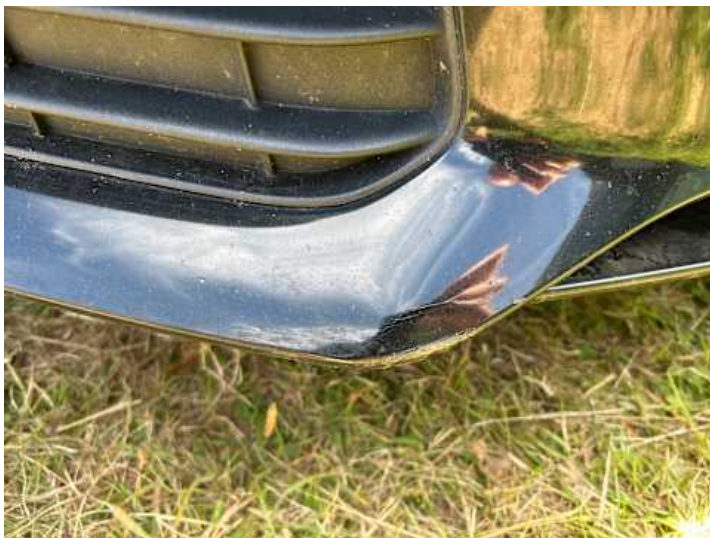
Stoßstange vorne (Lackschaden, Kratzer, Verformung)
