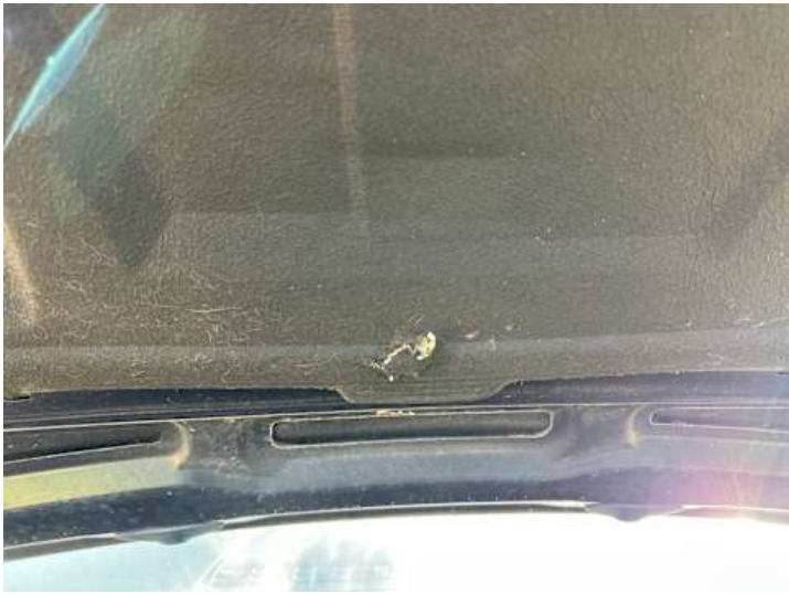
Motorhaube (Delle, Riss/Bruch, Steinschlag)
