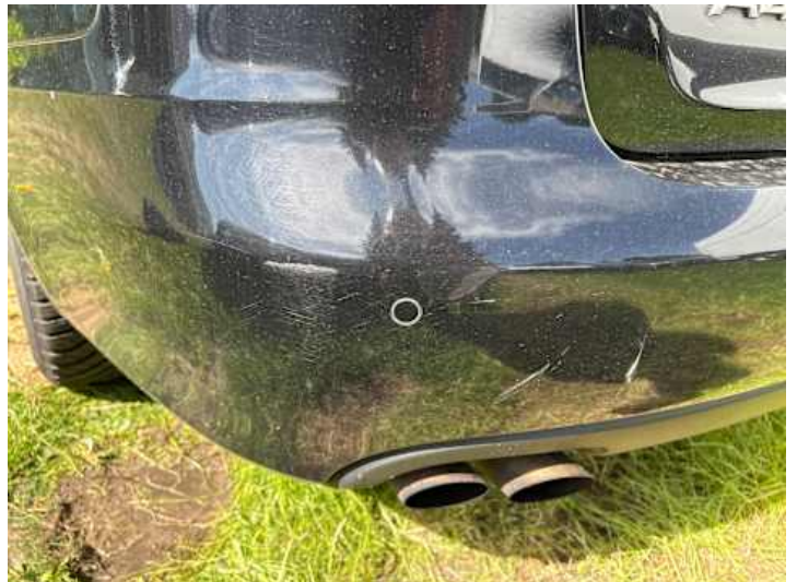
Stoßstange hinten (Riss/Bruch, Lackschaden)
