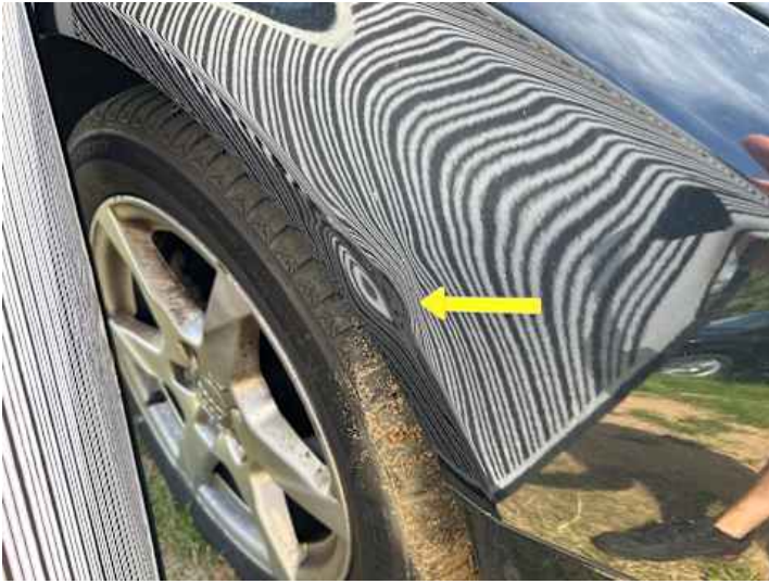
Kotflügel vorne rechts (Delle, Kratzer)
