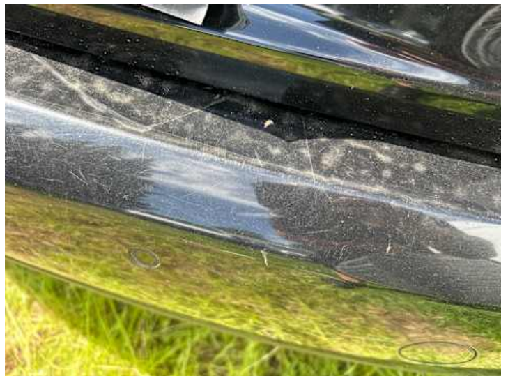
Stoßstange hinten (Riss/Bruch, Lackschaden)
