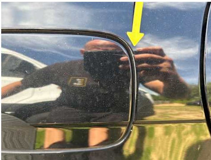
Seitenteil hinten rechts (Kratzer)
