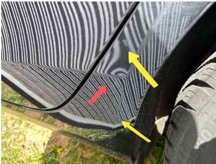
Seitenteil hinten links (Rost)
