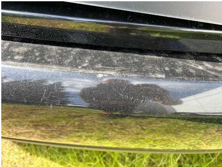
Stoßstange hinten (Riss/Bruch, Lackschaden)
