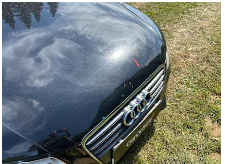
Motorhaube (Delle, Riss/Bruch, Steinschlag)
