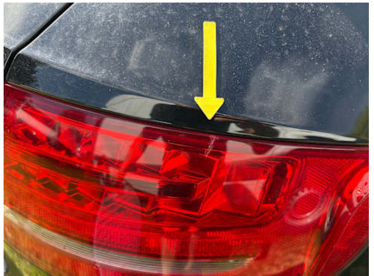
Rücklicht (rechts) (Riss/Bruch)
