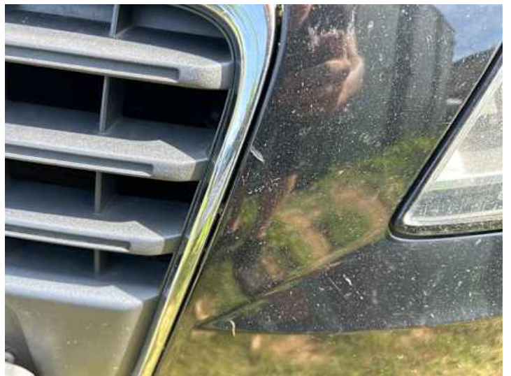
Stoßstange vorne (Lackschaden, Kratzer, Verformung)
