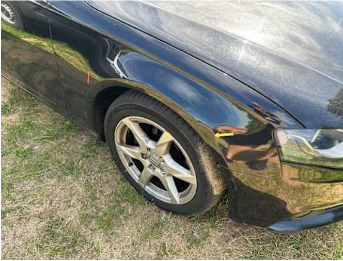
Kotflügel vorne rechts (Delle, Kratzer)
