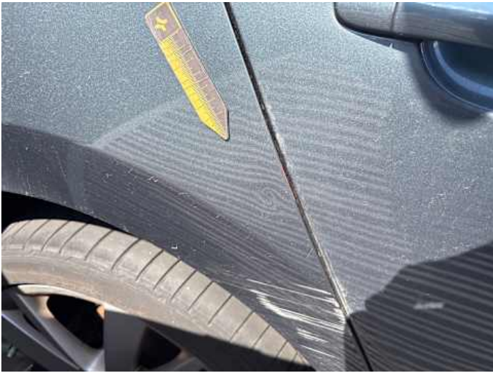
Seitenteil hinten rechts (Verformung)
