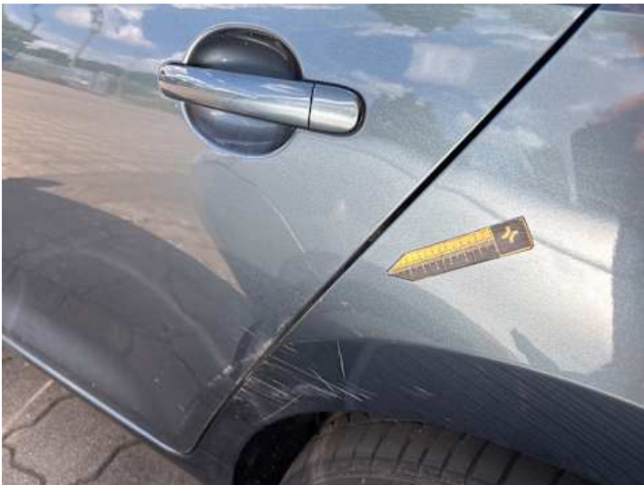
Seitenteil hinten links (Verformung)
