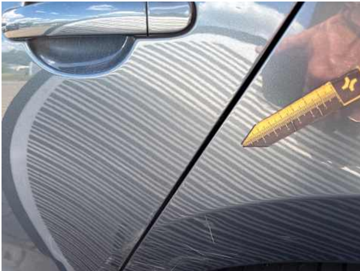
Seitenteil hinten links (Verformung)
