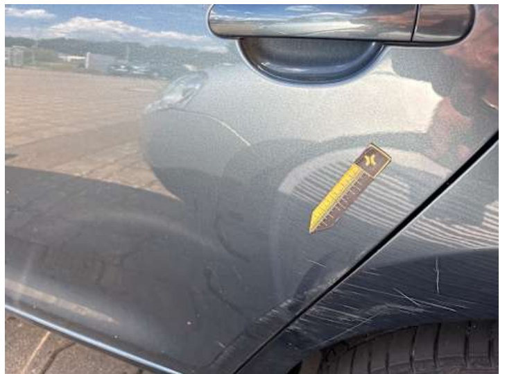
Türe hinten links (Kratzer)
