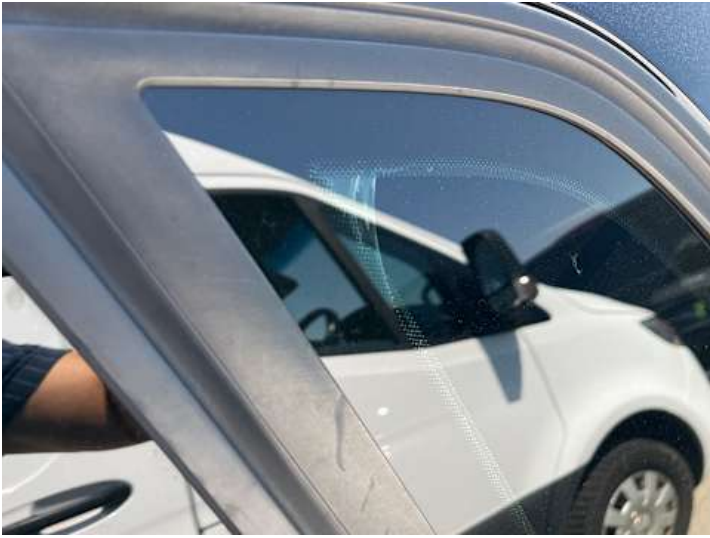
Seitenteil hinten links (Anderer Schaden): Folie löst sich
