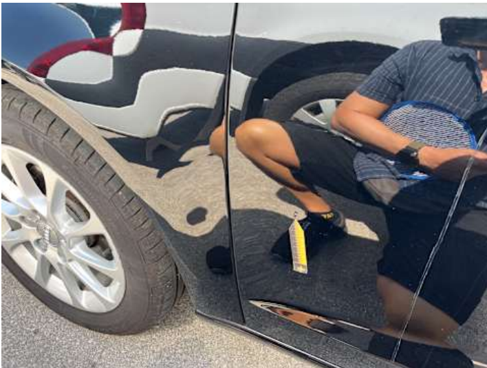
Fahrtür (Delle, Kratzer)
