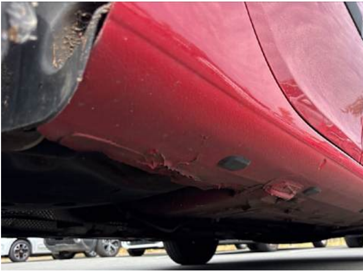
Schweller rechts (Verformung, Lackschaden)
