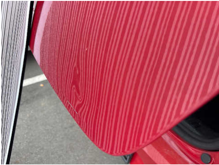
Heckklappe (Delle, Kratzer)
