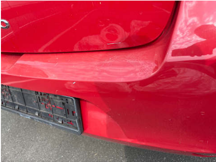
Stoßstange hinten (Kratzer, Lackschaden)
