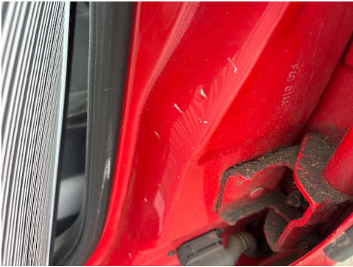
Fahrtür (Delle, Kratzer)
