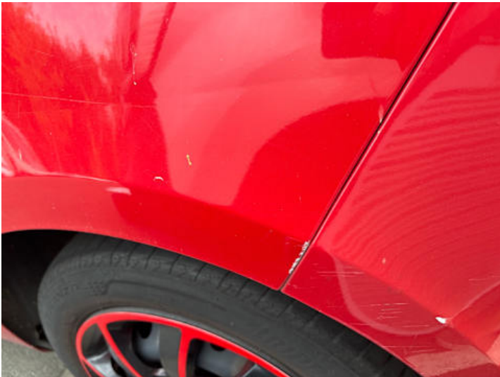
Seitenteil hinten links (Kratzer, Delle)
