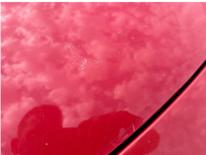
Motorhaube (Kratzer, Lackschaden)
