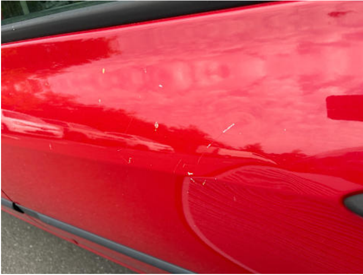
Türe hinten links (Kratzer, Delle)
