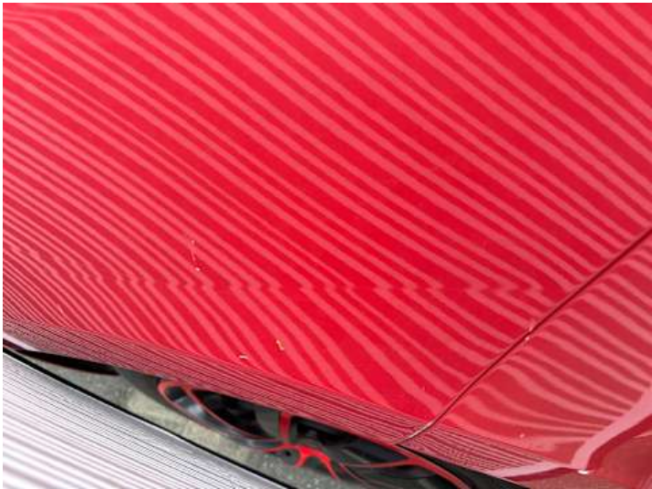
Seitenteil hinten links (Kratzer, Delle)
