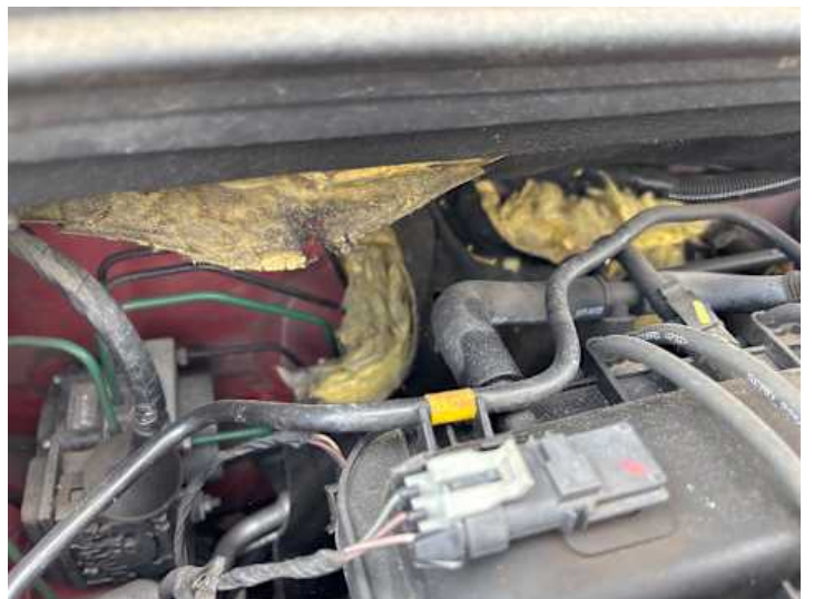
Motorhaube (Anderer Schaden, Riss/Bruch): Tier
