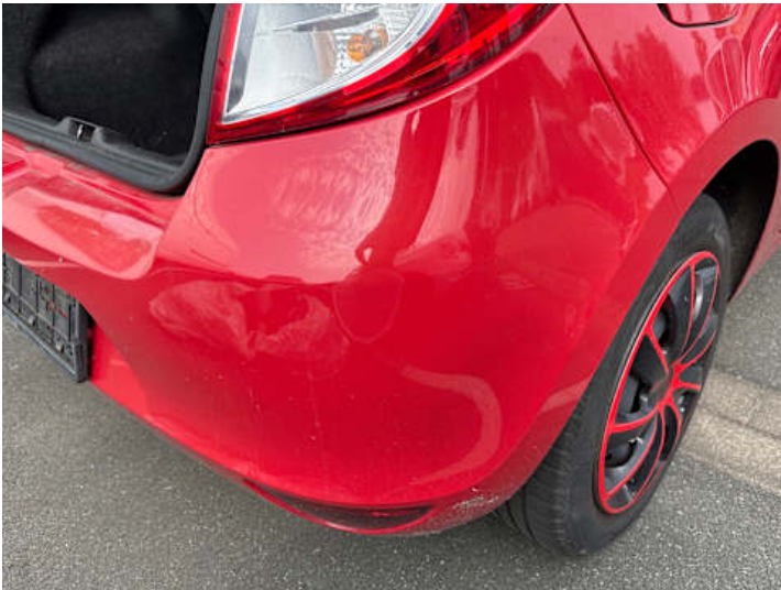
Stoßstange hinten (Kratzer, Lackschaden)
