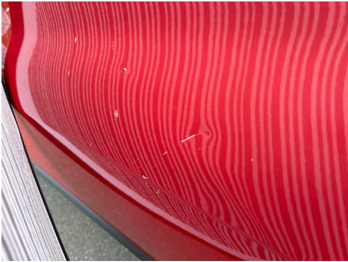
Türe hinten links (Kratzer, Delle)
