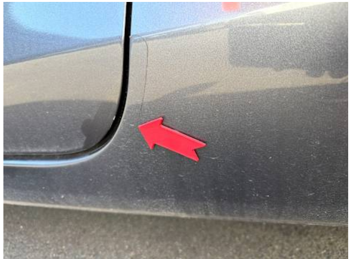
Fahrertür (Lackschaden, Kratzer)
