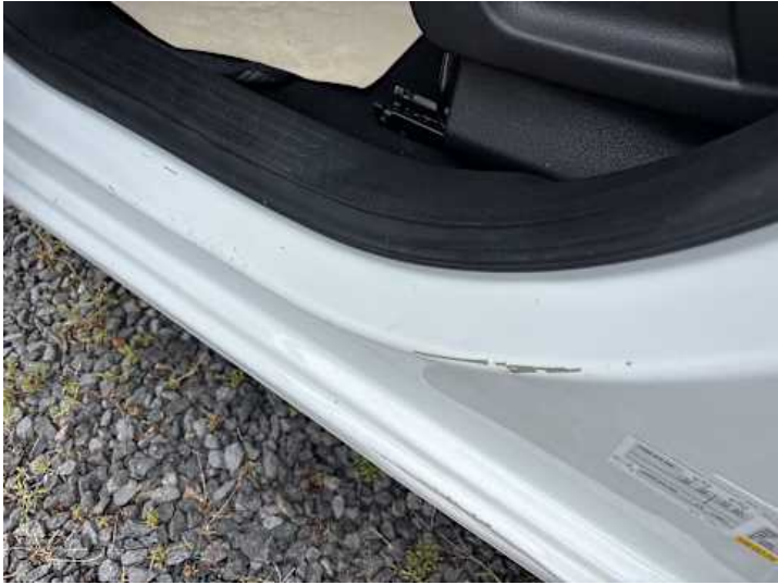
Schweller links (Lackschaden, Delle)
