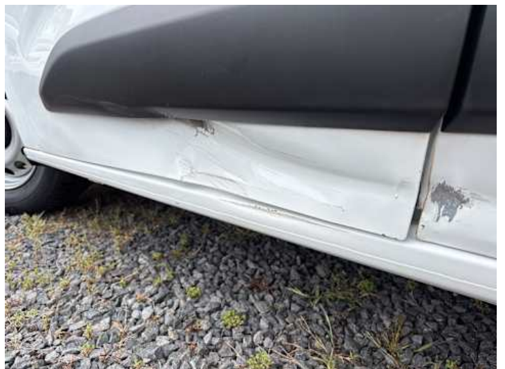
Fahrtür (Delle, Lackschaden, Verformung)
