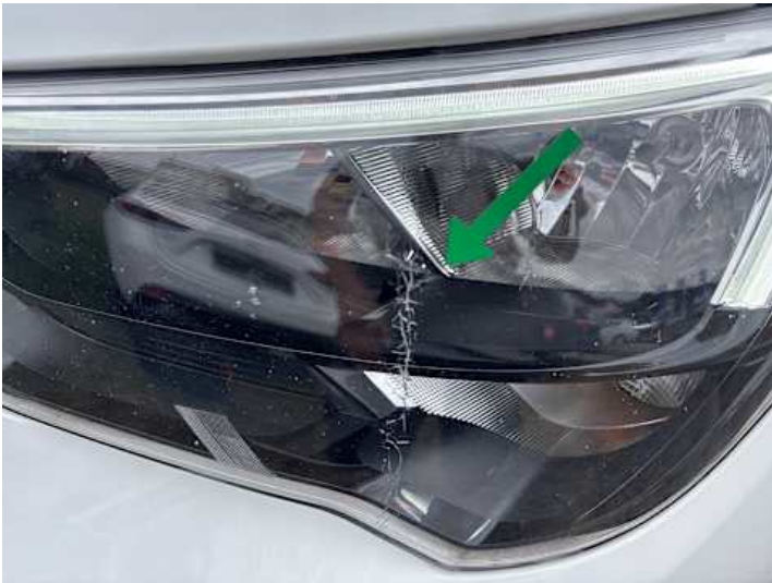
Scheinwerfer (links) (Riss/Bruch)
