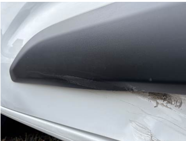
Fahrtür (Delle, Lackschaden, Verformung)
