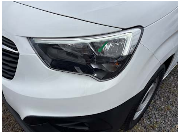
Scheinwerfer (links) (Riss/Bruch)
