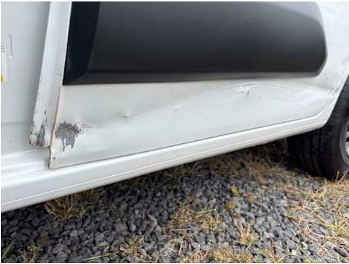
Türe hinten links (Delle, Lackschaden, Verformung)
