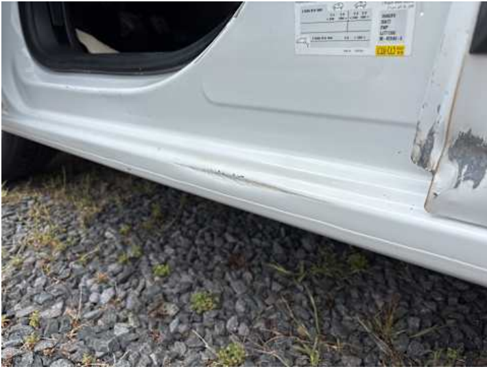
Schweller links (Lackschaden, Delle)
