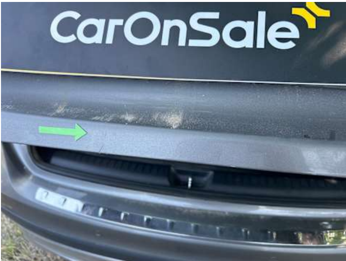
Heckklappe (Rost, Kratzer)
