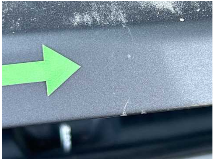
Heckklappe (Rost, Kratzer)
