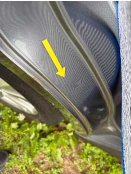
Schweller rechts (Delle, Kratzer)
