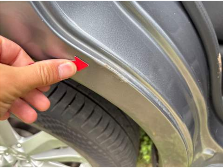
Seitenteil hinten rechts (Rost, Lackschaden)
