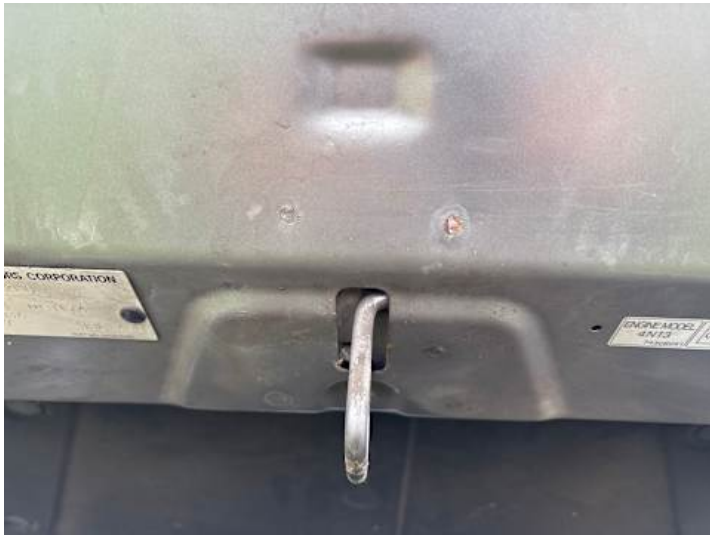
Motorhaube (Kratzer, Rost)
