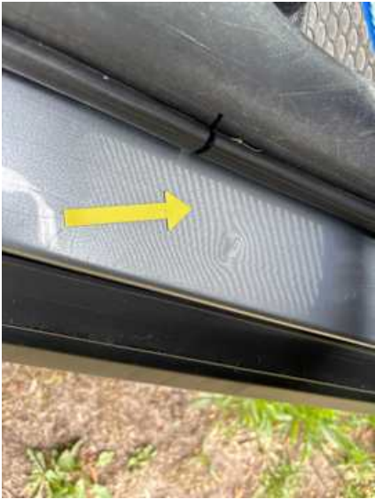
Schweller rechts (Delle, Kratzer)
