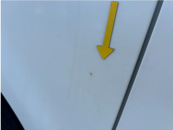
Seitenteil hinten rechts (Kratzer, Rost)
