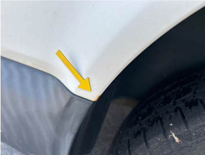
Seitenteil hinten rechts (Kratzer, Rost)
