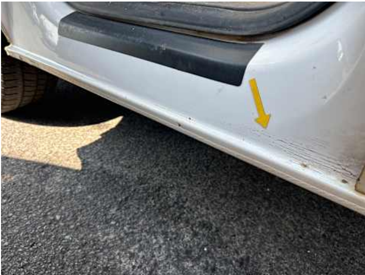
Schweller links (Kratzer, Rost)
