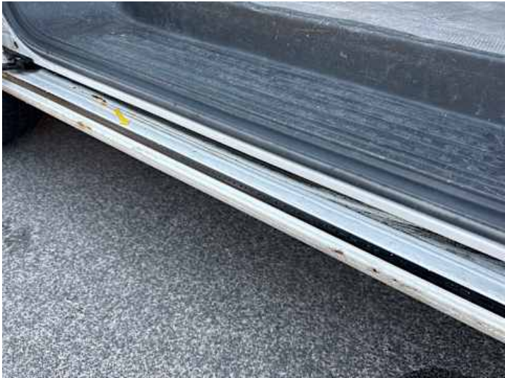
Schweller rechts (Kratzer, Verformung, Rost)
