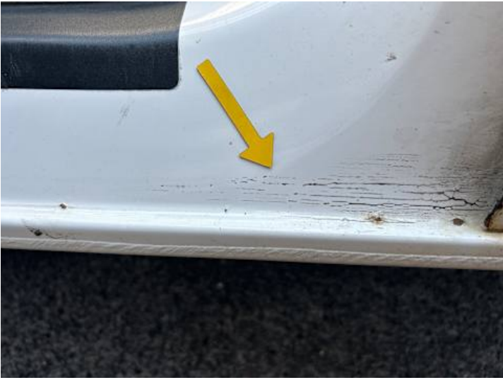
Schweller links (Kratzer, Rost)
