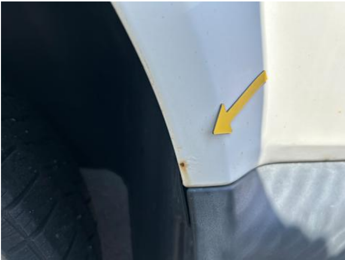
Seitenteil hinten links (Rost)
