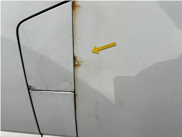
Türe hinten links (Kratzer, Rost)
