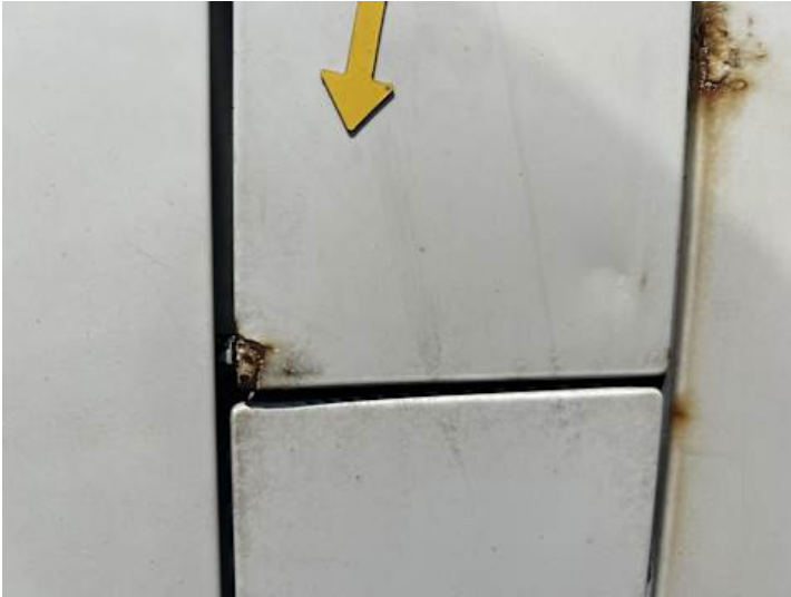
Türe hinten links (Kratzer, Delle, Rost)
