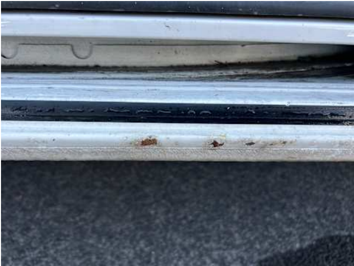
Schweller rechts (Kratzer, Verformung, Rost)
