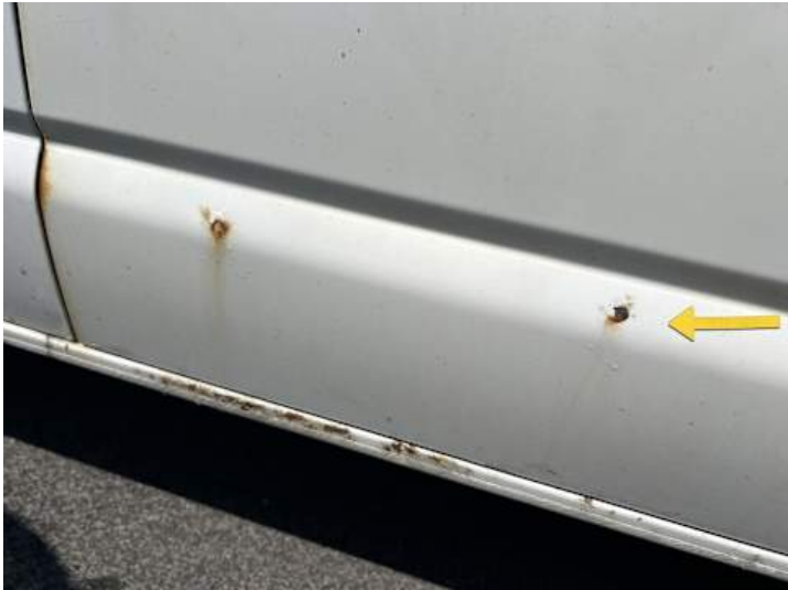
Türe hinten links (Kratzer, Rost)
