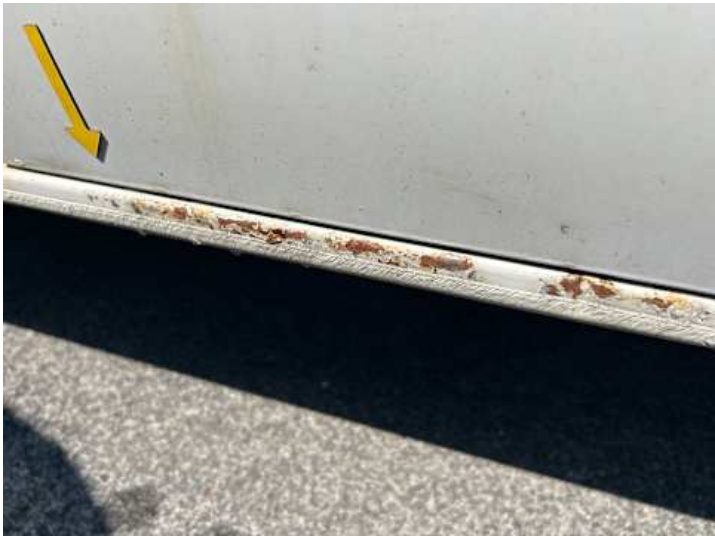
Schweller links (Kratzer, Rost, Verformung)
