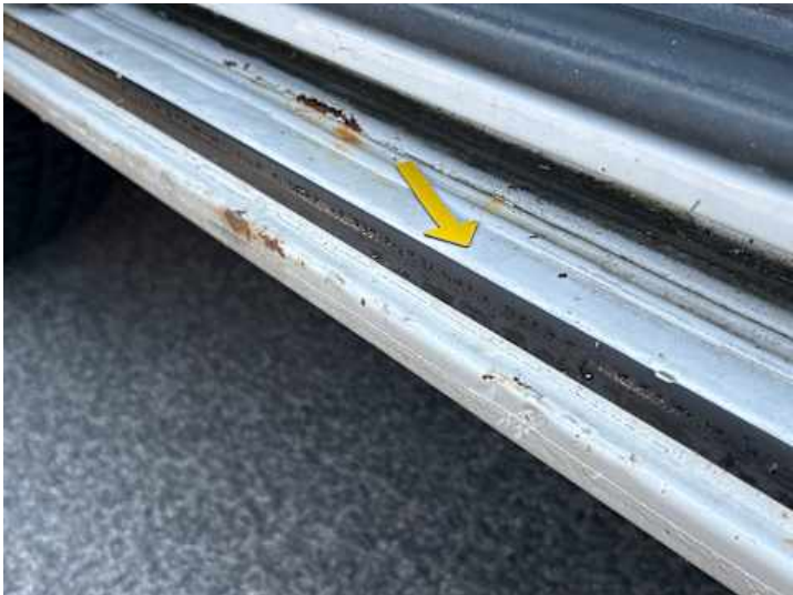
Schweller rechts (Kratzer, Verformung, Rost)
