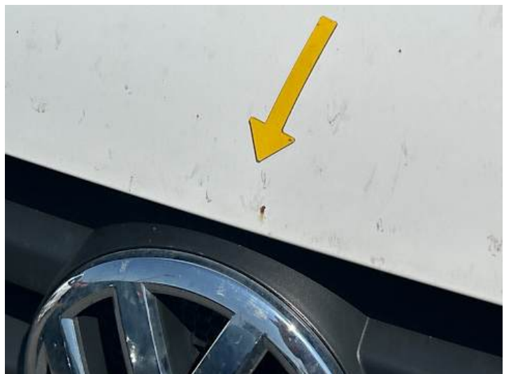
Motorhaube (Steinschlag, Rost)
