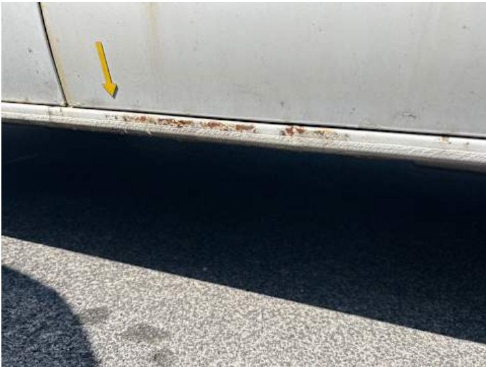
Schweller links (Kratzer, Rost, Verformung)
