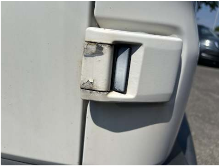
Heckklappe (Kratzer, Rost)
