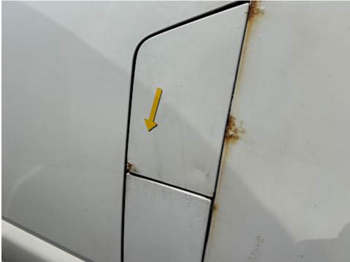
Türe hinten links (Kratzer, Delle, Rost)
