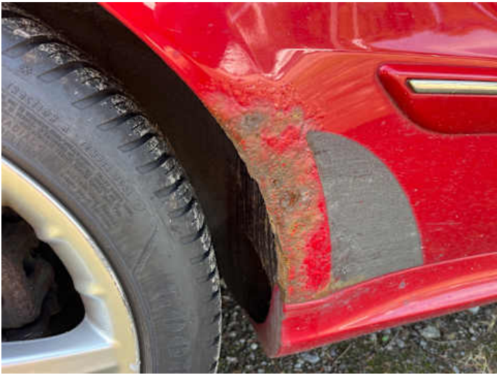
Seitenteil hinten rechts (Rost, Lackschaden, Verformung)
