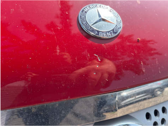
Motorhaube (Delle, Steinschlag)
