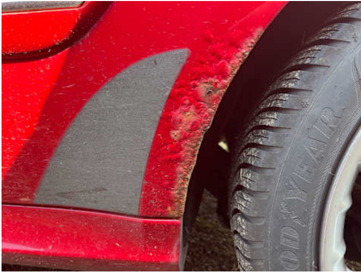
Seitenteil hinten links (Kratzer, Lackschaden, Rost)
