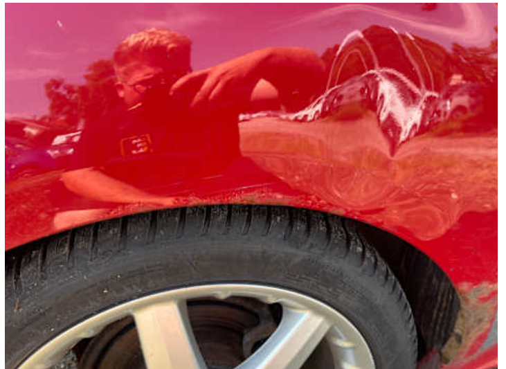
Seitenteil hinten rechts (Rost, Lackschaden, Verformung)
