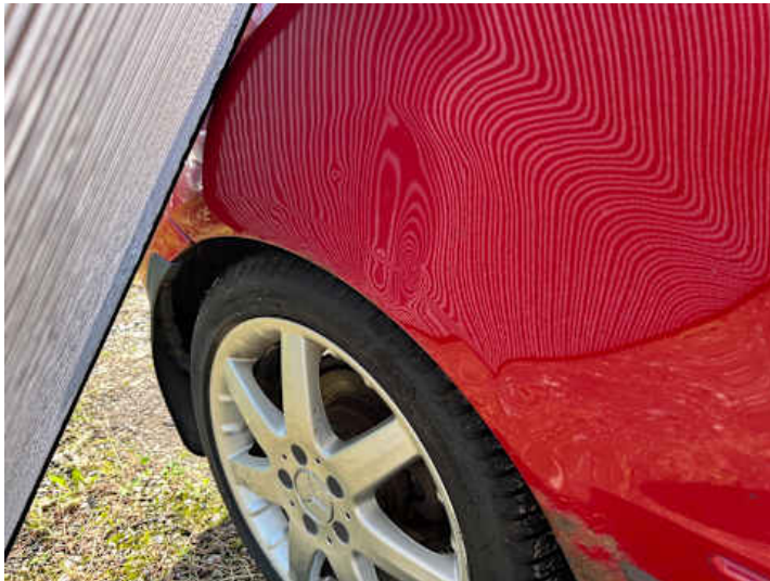
Seitenteil hinten rechts (Lackschaden, Verformung)
