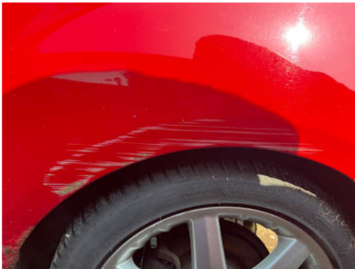
Seitenteil hinten links (Kratzer, Lackschaden, Rost)
