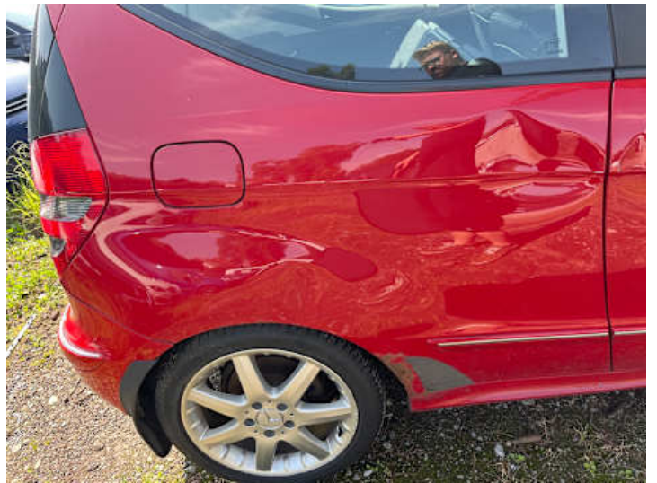
Seitenteil hinten rechts (Lackschaden, Verformung)
