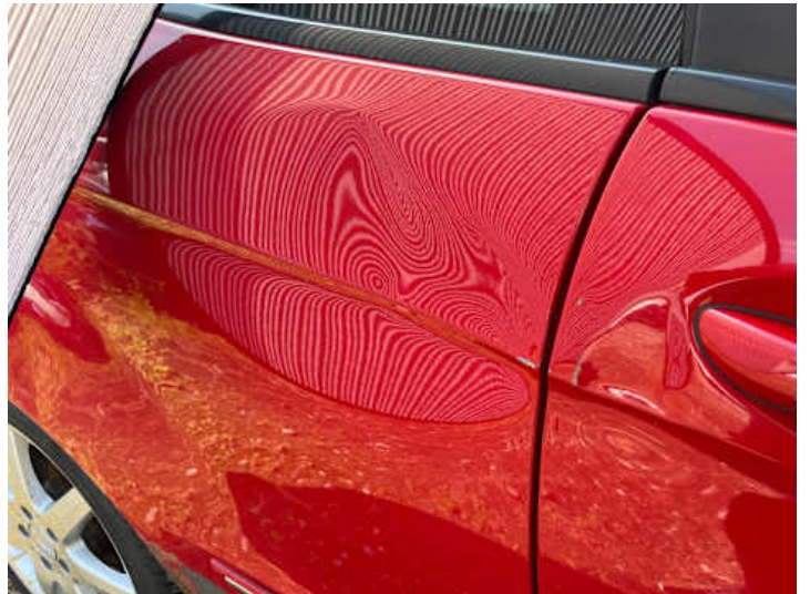
Seitenteil hinten rechts (Lackschaden, Verformung)
