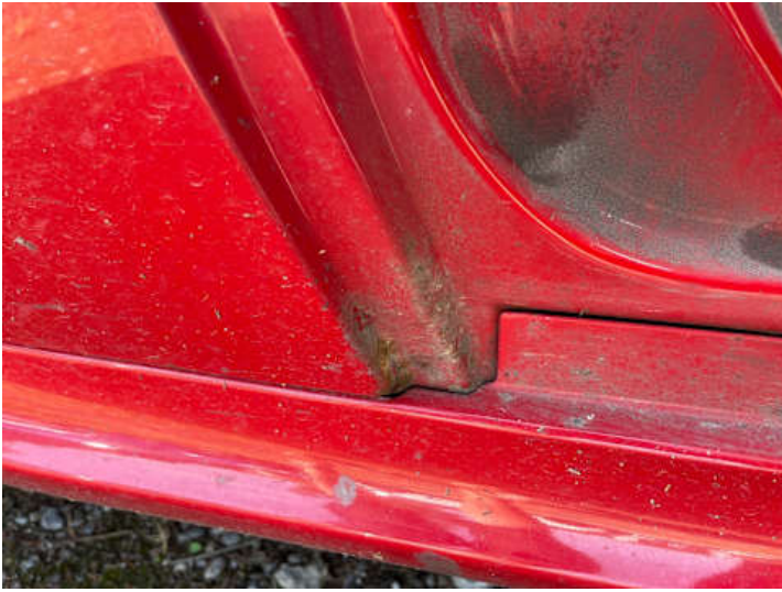
Seitenteil hinten links (Kratzer, Lackschaden, Rost)
