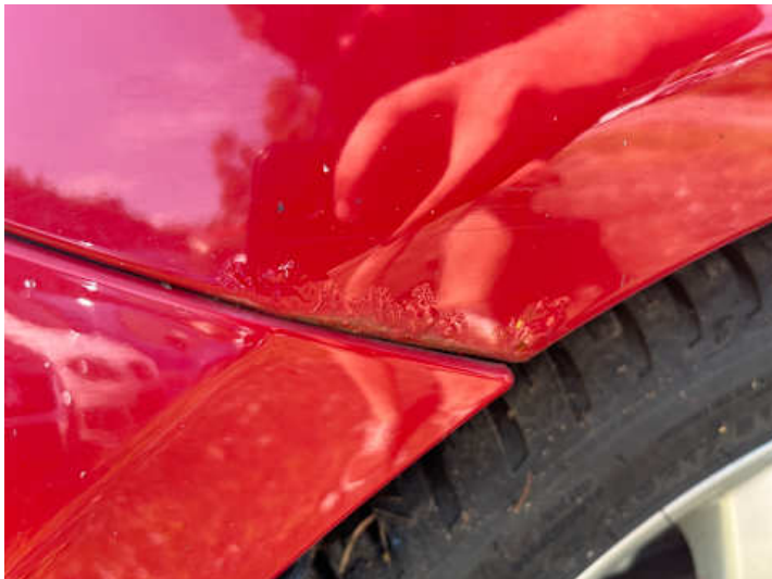
Seitenteil hinten rechts (Rost, Lackschaden, Verformung)
