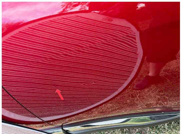
Türe hinten links (Delle)
