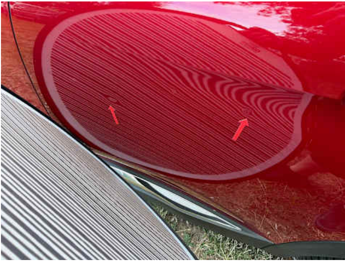
Türe hinten links (Delle)
