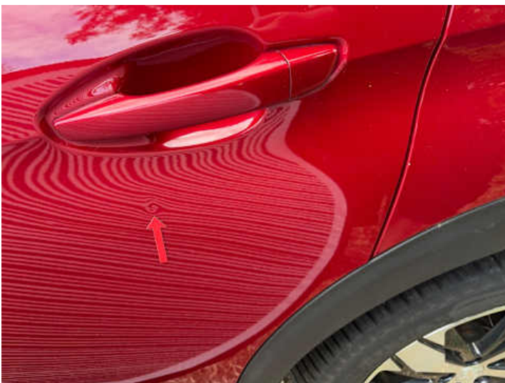
Türe hinten links (Delle)
