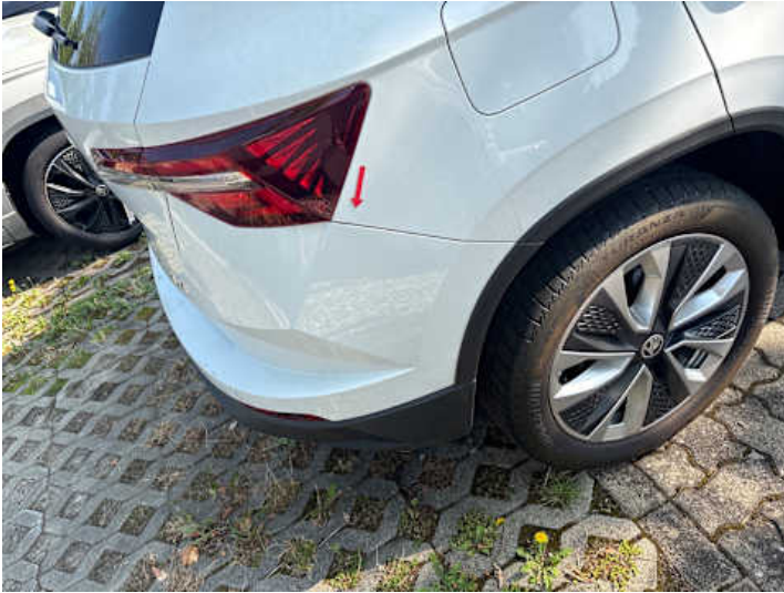
Stoßstange hinten (Spaltmaße ungenau)
