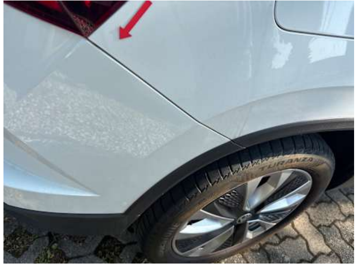
Stoßstange hinten (Spaltmaße ungenau)
