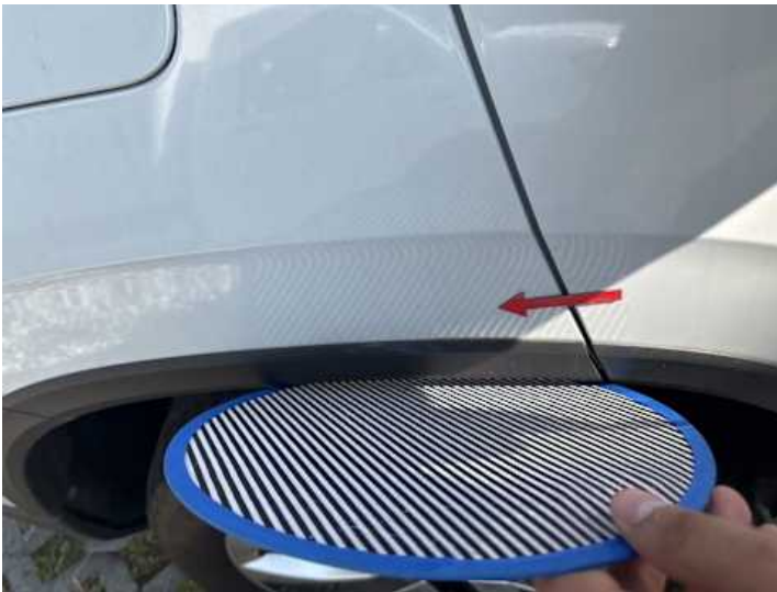
Seitenteil hinten rechts (Kratzer, Delle)
