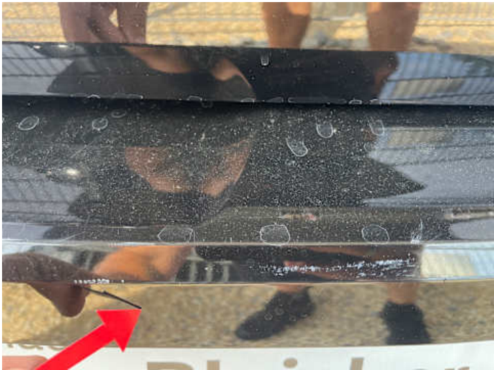
Stoßstange hinten (Lackschaden)
