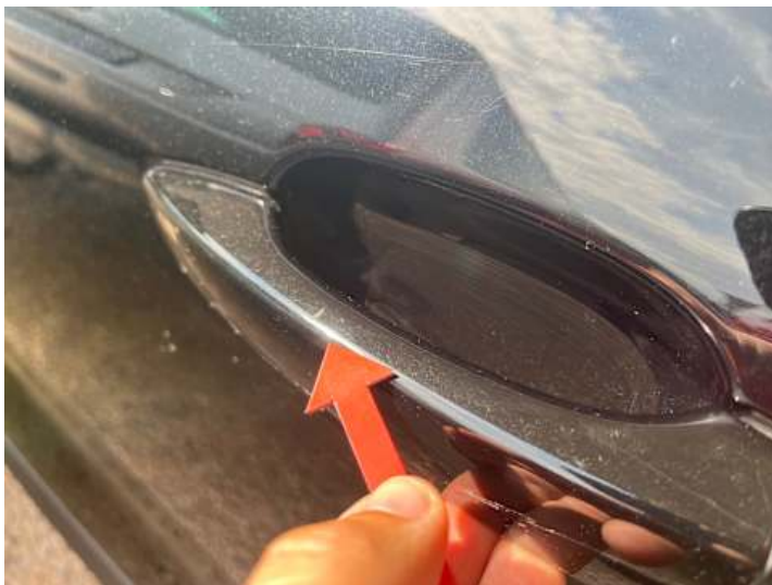
Fahrtür (Kratzer, Lackschaden)
