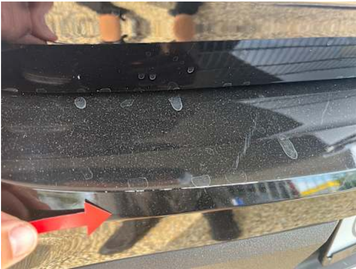
Stoßstange hinten (Lackschaden)
