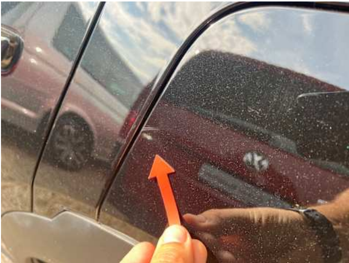
Seitenteil hinten links (Kratzer)
