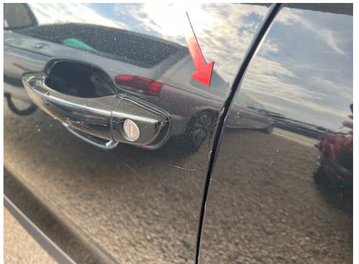
Fahrtür (Kratzer, Lackschaden)
