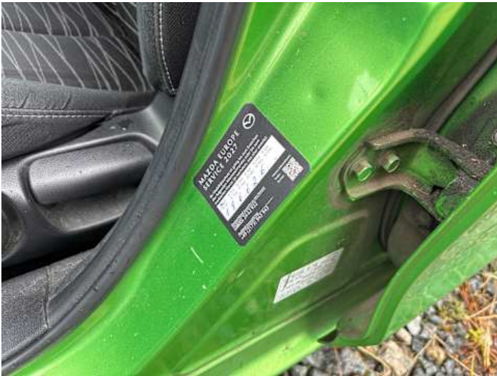
Schweller links (Kratzer, Delle)
