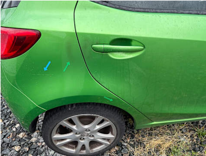
Seitenteil hinten rechts (Delle, Ausgeblichen/Matt, Kratzer, Unsachgemäß instand gesetzt, Anderer Schaden): Farbtonunterschiede,
