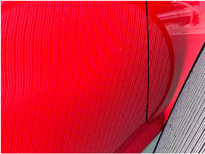
Seitenteil hinten rechts (Delle, Verformung)
