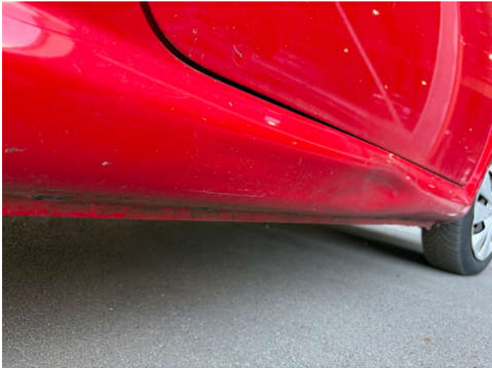
Schweller rechts (Verformung)
