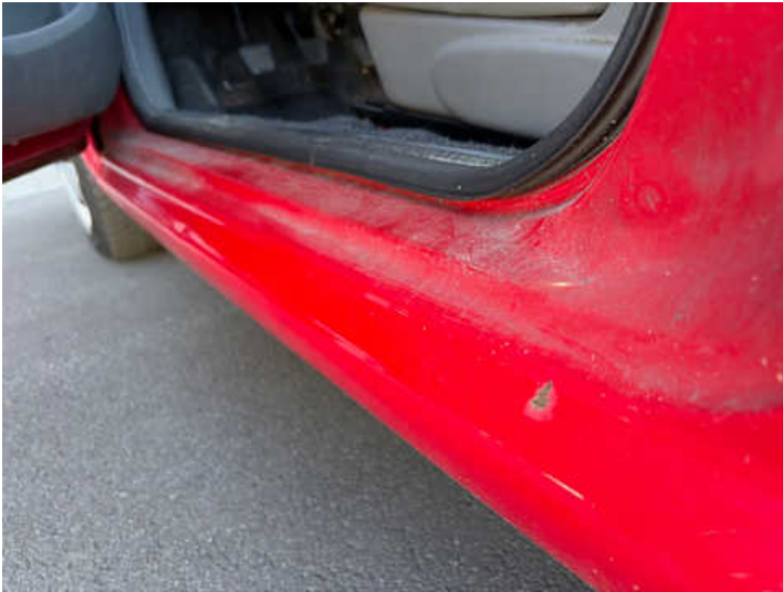
Schweller links (Rost)
