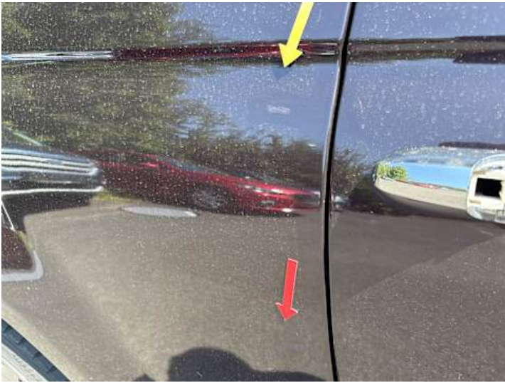
Seitenteil hinten rechts (Lackschaden, Unsachgemäß instand gesetzt)
