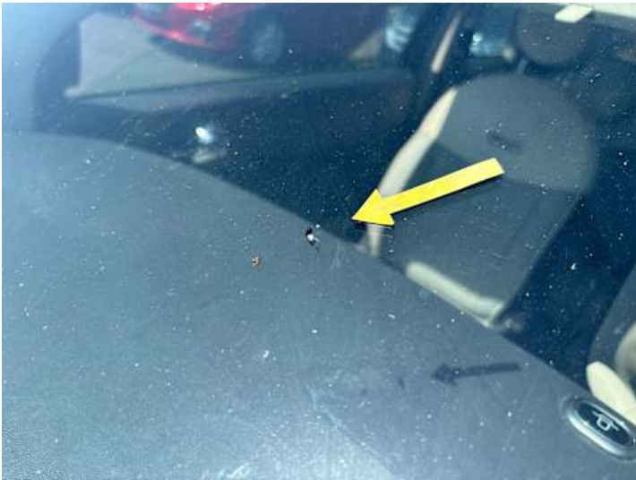
Windschutzscheibe (Steinschlag, Riss/Bruch)
