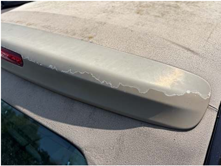
Dach (Anderer Schaden): Lack löst sich
