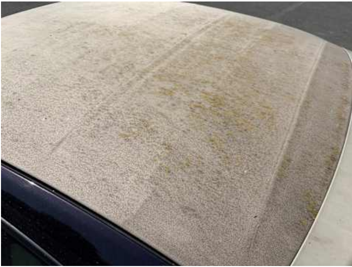
Dach (Anderer Schaden): Verschmutzung
