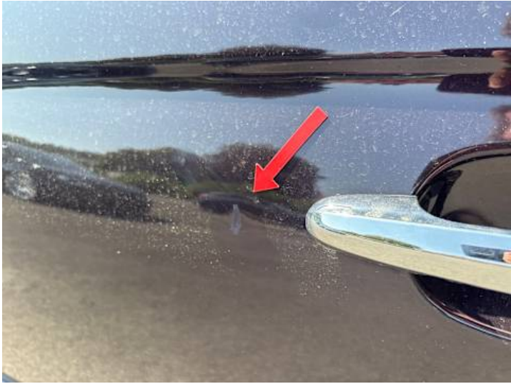
Fahrtür (Lackschaden, Unsachgemäß instand gesetzt)
