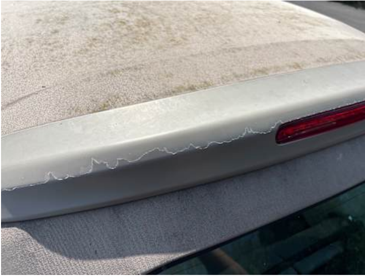
Dach (Anderer Schaden): Lack löst sich
