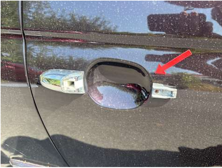
Beifahrtür (Riss/Bruch, Anderer Schaden): Griff fehlt
