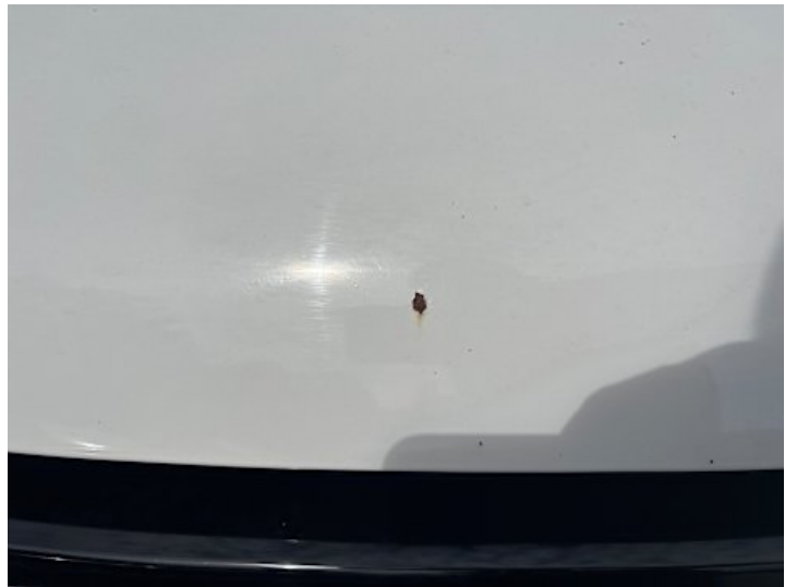
Motorhaube (Lackschaden, Rost)
