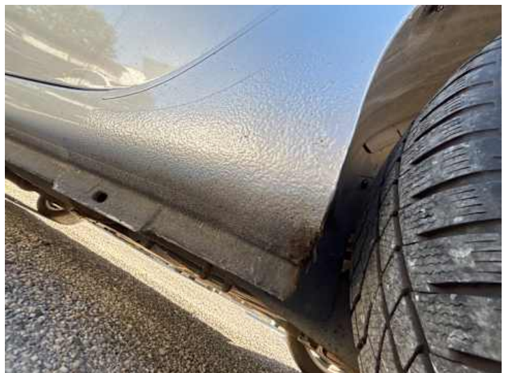
Schweller links (Rost)
