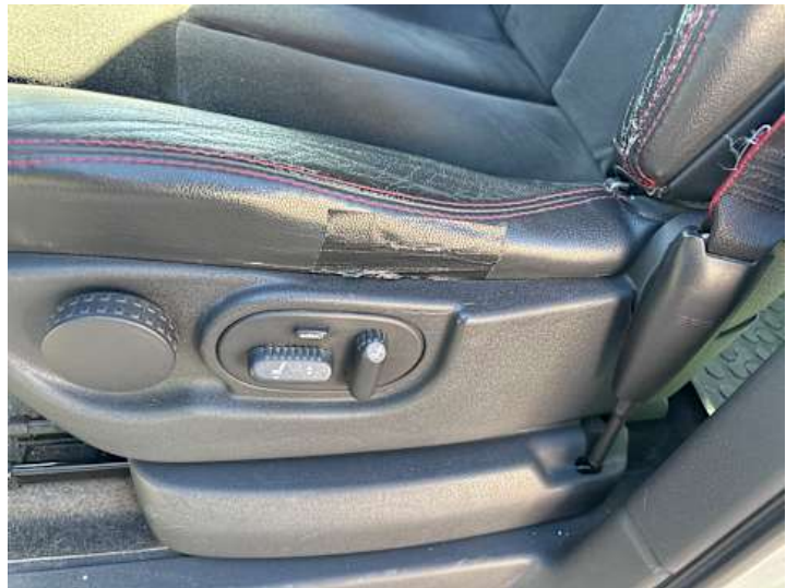
Innenraum (Riss/Bruch, Verschleiß, Kratzer)
