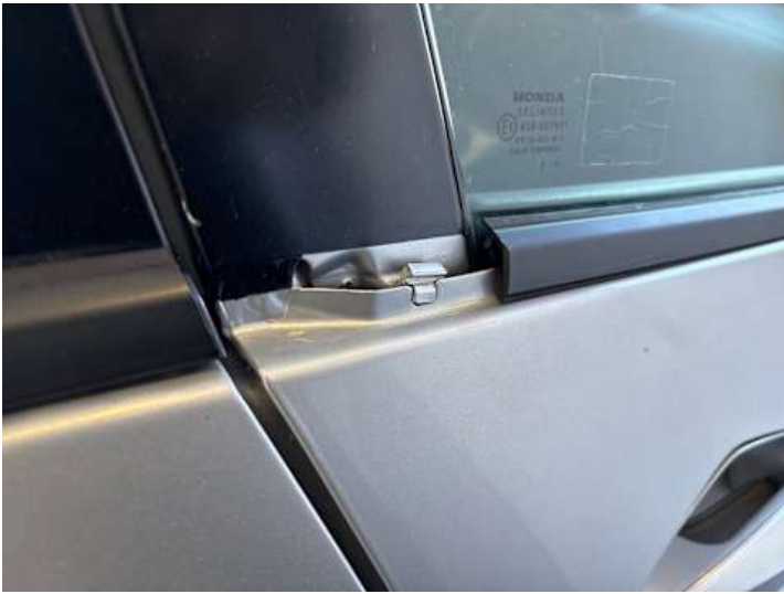
Beifahrertür (Anderer Schaden): Gummidichtung beschädigt
