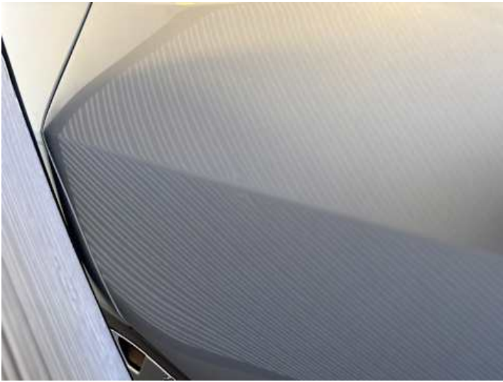
Türe hinten rechts (Delle)
