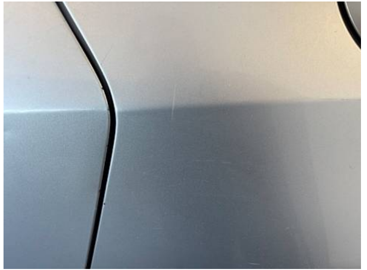
Türe hinten links (Kratzer)
