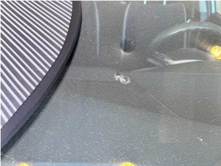
Windschutzscheibe (Riss/Bruch, Steinschlag)
