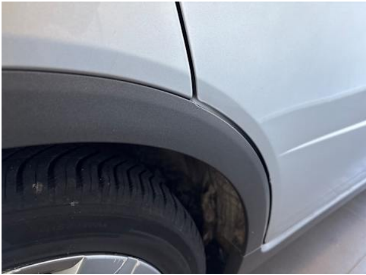
Seitenteil hinten rechts (Spaltmaße ungenau)
