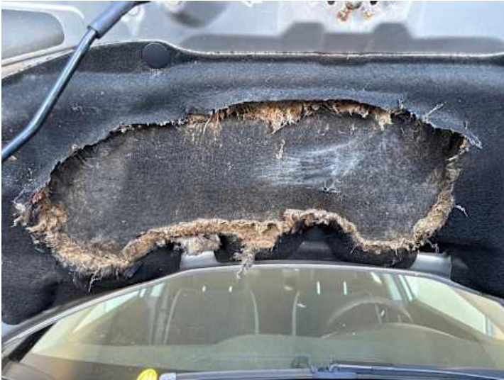
Motorhaube (Anderer Schaden): Motordämmung beschädigt
