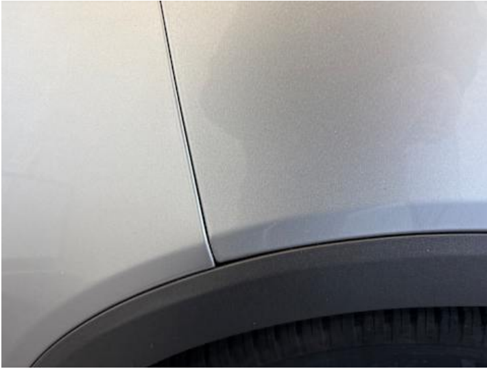
Seitenteil hinten rechts (Spaltmaße ungenau)
