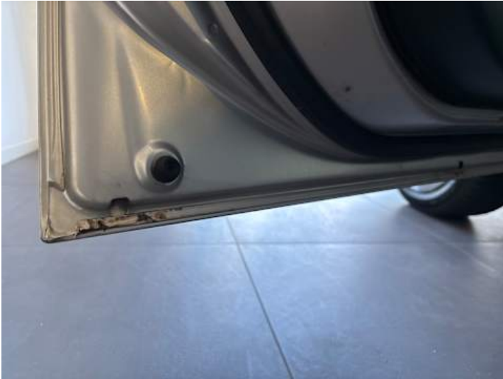
Fahrtür (Lackschaden, Rost)
