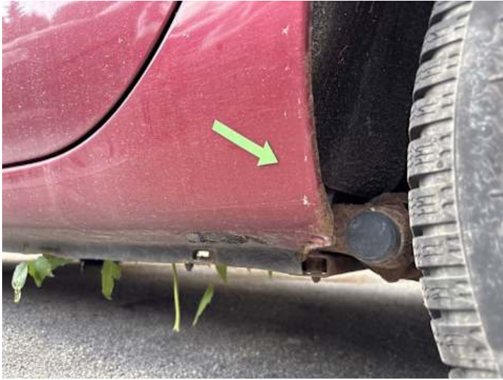
Schweller links (Rost)
