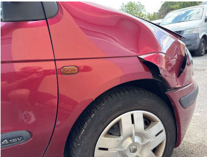
Kotflügel vorne rechts (Riss/Bruch, Spaltmaße ungenau)
