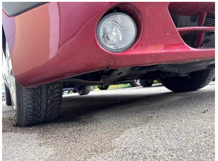
Stoßstange vorne (Riss/Bruch)
