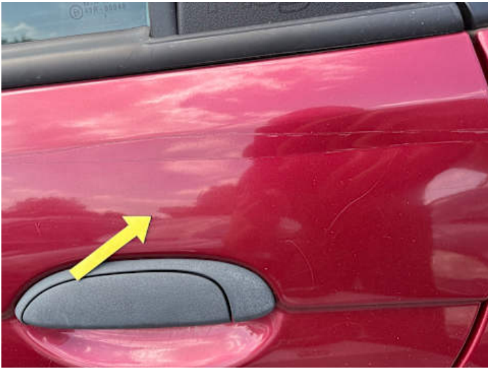
Türe hinten links (Verformung, Kratzer)
