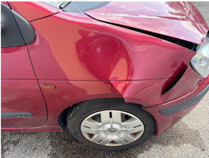
Kotflügel vorne rechts (Riss/Bruch, Spaltmaße ungenau)
