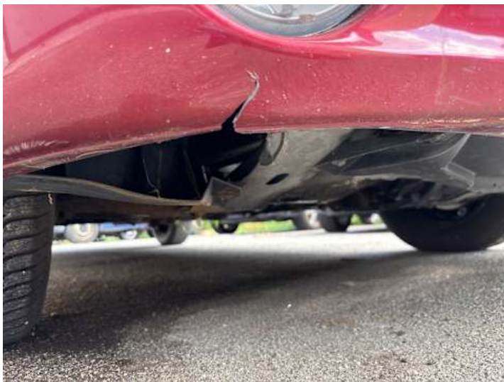
Stoßstange vorne (Riss/Bruch)
