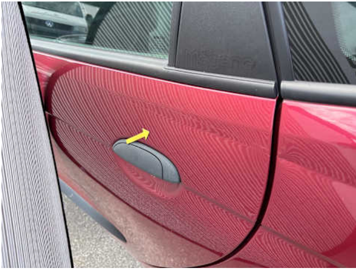
Türe hinten links (Verformung, Kratzer)
