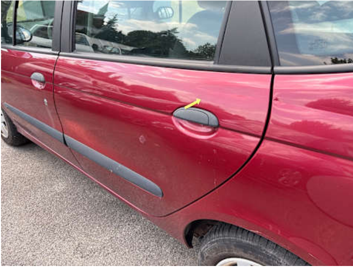
Türe hinten links (Verformung, Kratzer)
