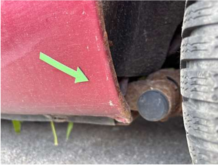
Schweller links (Rost)
