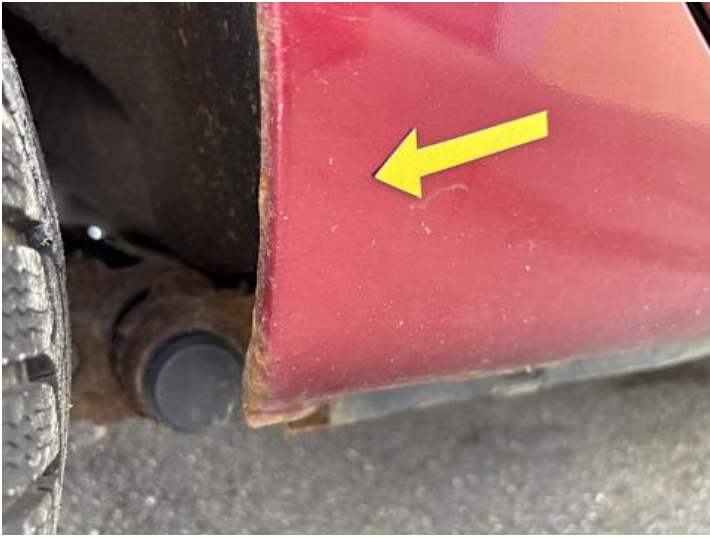
Schweller rechts (Rost)
