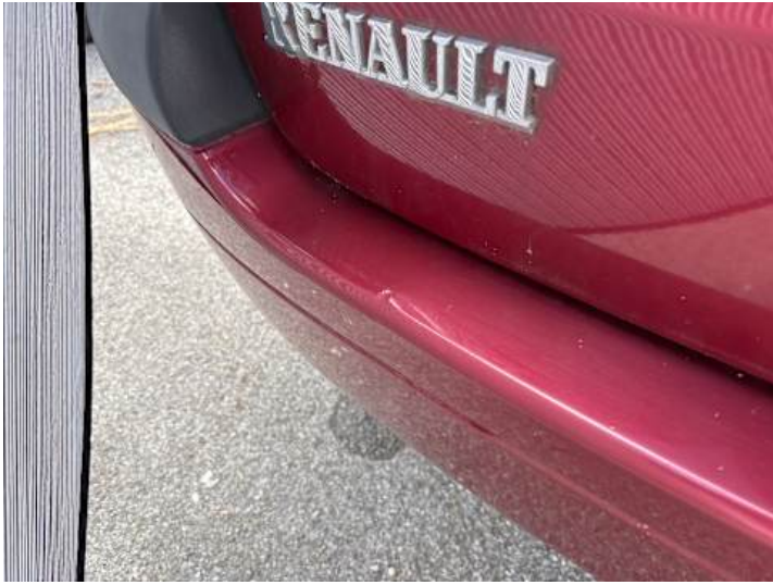
Stoßstange hinten (Verformung)
