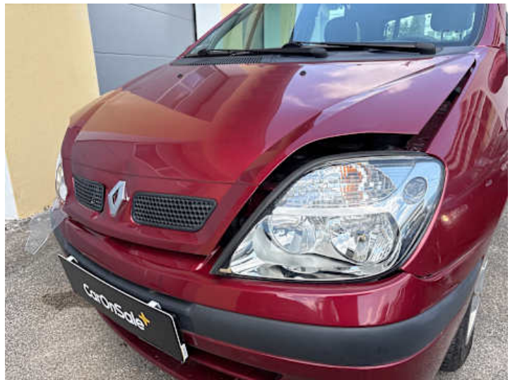
Motorhaube (Verformung, Spaltmaße ungenau)
