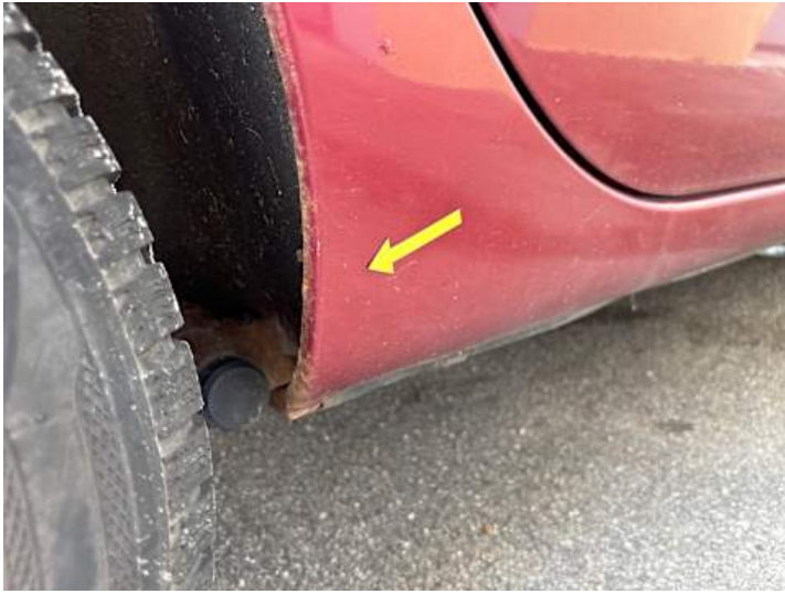
Schweller rechts (Rost)
