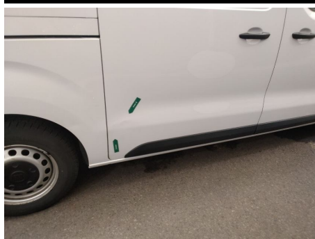
Tür / Rechts / Delle
