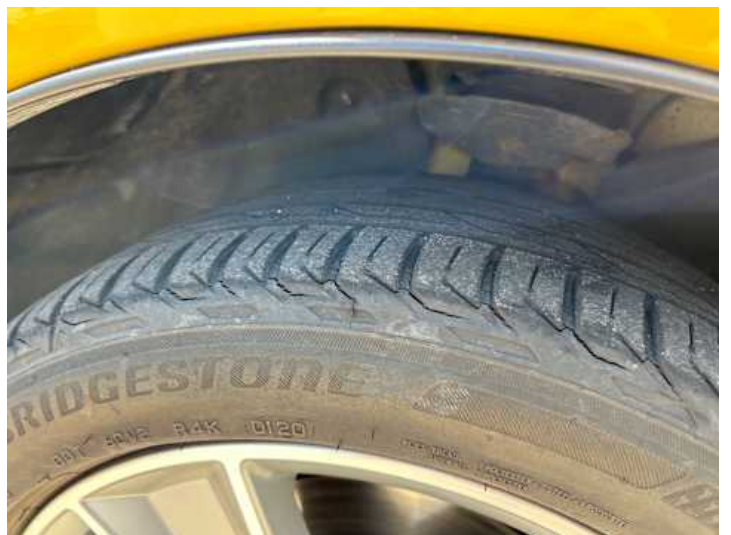
Rad (Anderer Schaden): Reifen porös;
