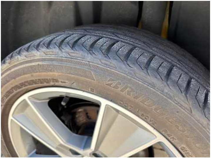
Rad (Anderer Schaden): Reifen porös;
