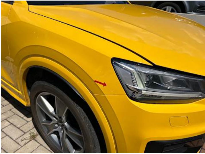
Kotflügel vorne rechts (Steinschlag)
