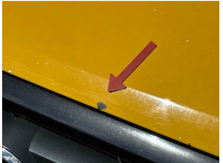
Motorhaube (Steinschlag, Rost)
