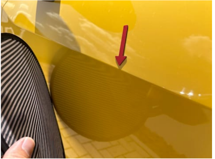
Fahrtür (Unsachgemäß instand gesetzt)
