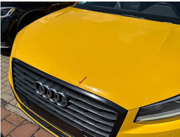
Motorhaube (Steinschlag, Rost)
