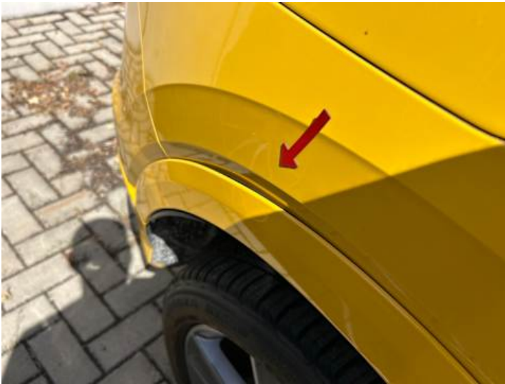
Seitenteil hinten rechts (Kratzer, Spaltmaße ungenau)
