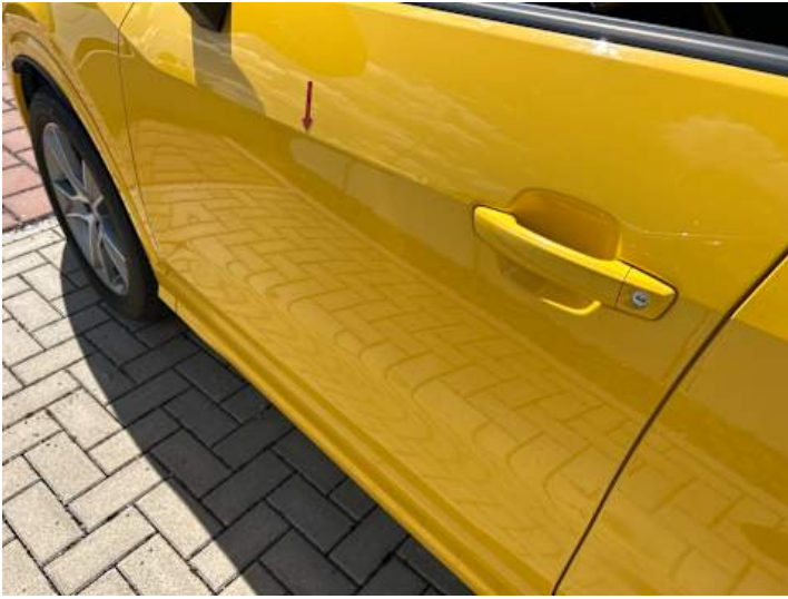
Fahrtür (Unsachgemäß instand gesetzt)
