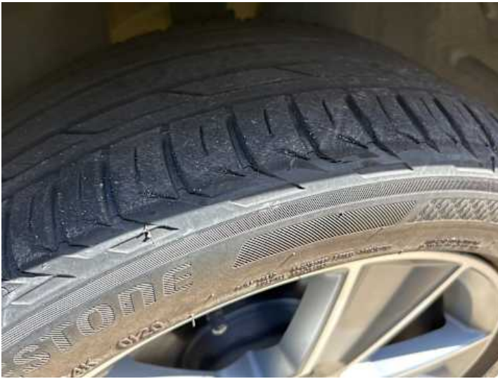
Rad (Anderer Schaden): Reifen porös;
