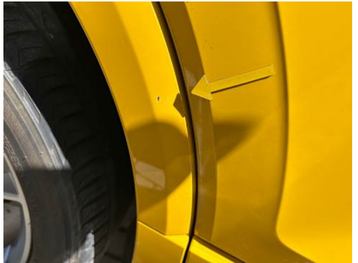
Seitenteil hinten rechts (Kratzer, Spaltmaße ungenau)
