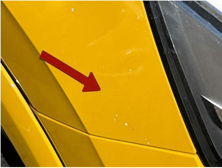
Kotflügel vorne rechts (Steinschlag)
