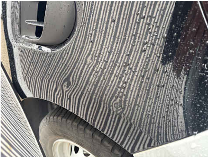
Seitenteil hinten links (Delle, Kratzer)
