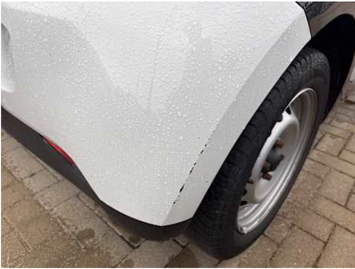
Stoßstange hinten (Kratzer)
