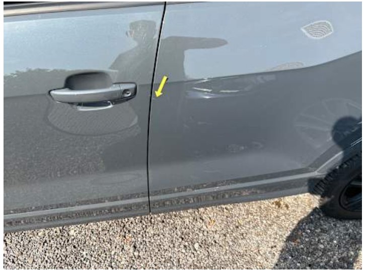
Türe hinten links (Kratzer, Lackschaden)
