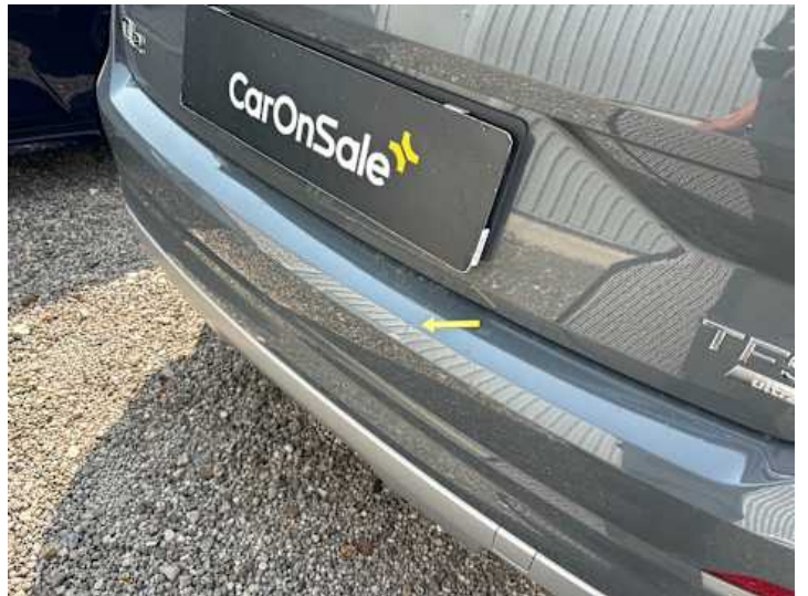
Stoßstange hinten (Kratzer, Lackschaden)
