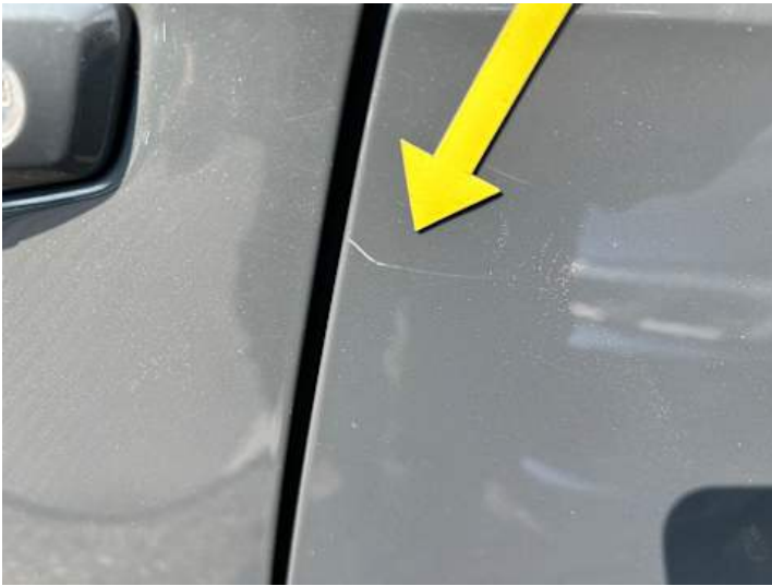
Türe hinten links (Kratzer, Lackschaden)
