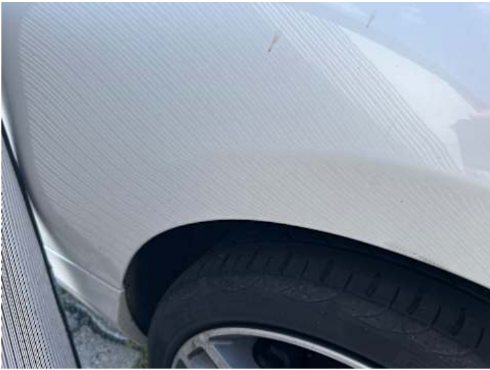
Seitenteil hinten links (Delle, Unsachgemäß instand gesetzt)
