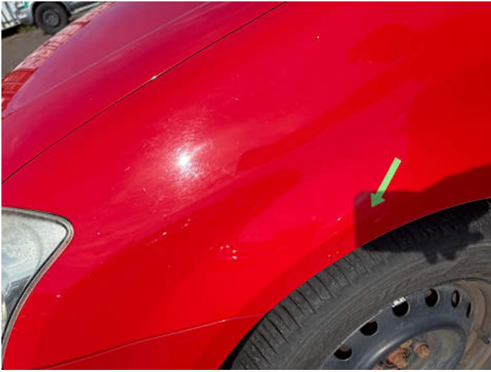
Kotflügel vorne links (Steinschlag)
