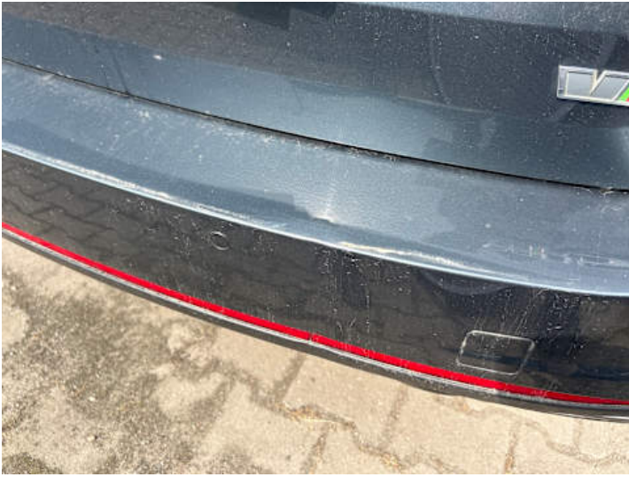
Stoßstange hinten (Verformung)
