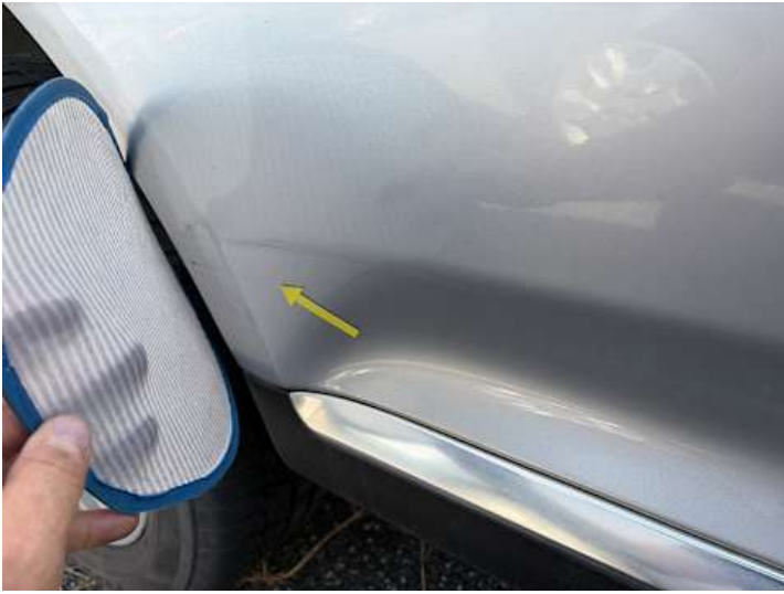
Türe hinten rechts (Kratzer, Verformung, Rost)
