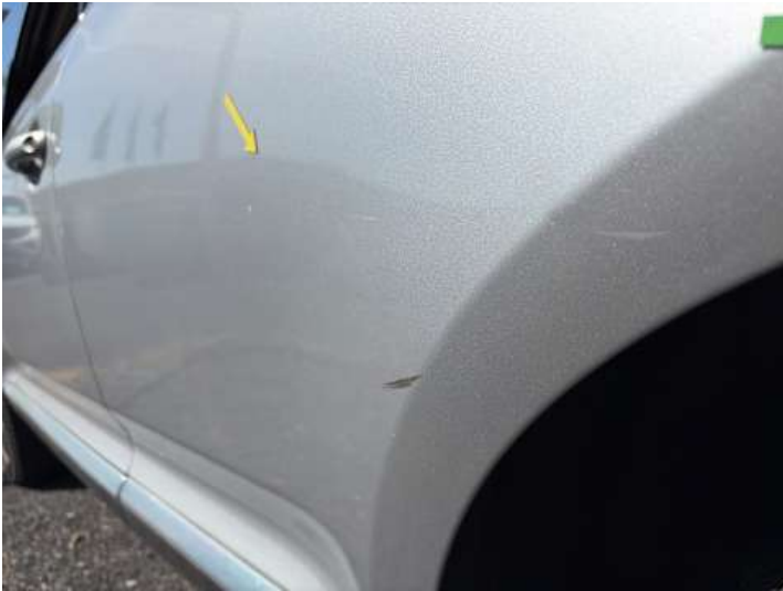
Türe hinten links (Rost, Kratzer, Delle)
