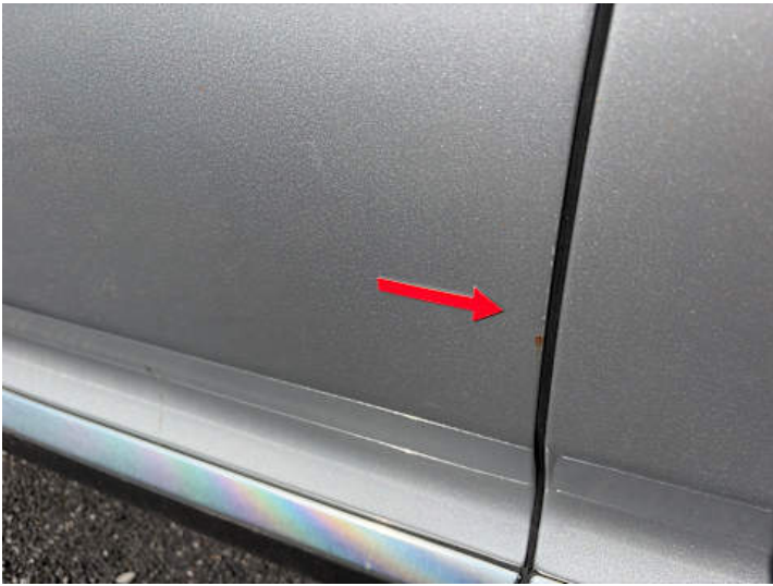
Fahrtür (Kratzer, Delle, Rost)
