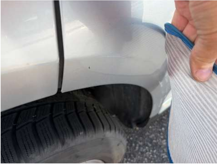
Türe hinten rechts (Kratzer, Verformung, Rost)
