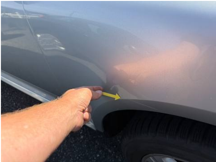
Kotflügel vorne rechts (Kratzer, Lackschaden)
