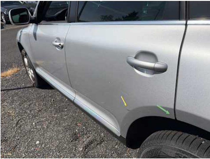
Türe hinten links (Rost, Kratzer, Delle)
