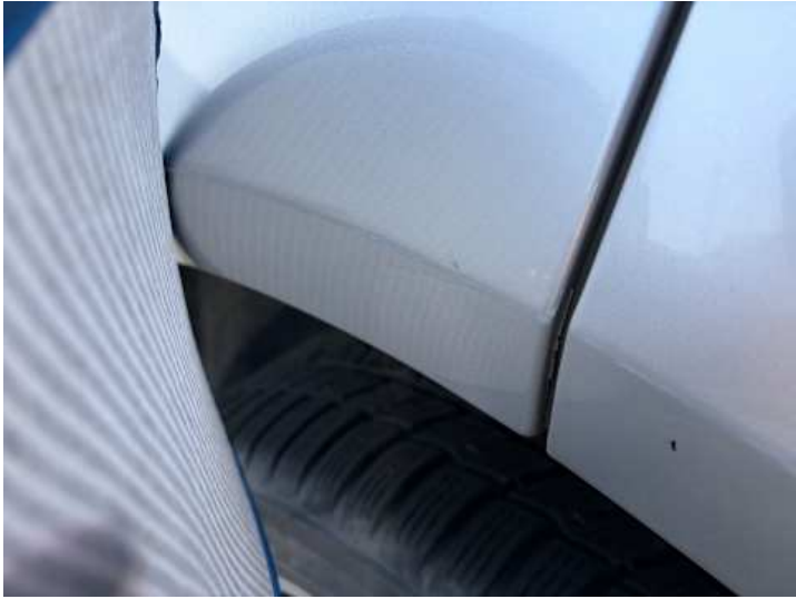
Seitenteil hinten rechts (Kratzer, Delle)
