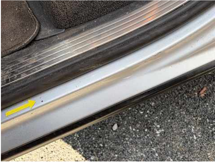
Fahrtür (Kratzer, Delle, Rost)
