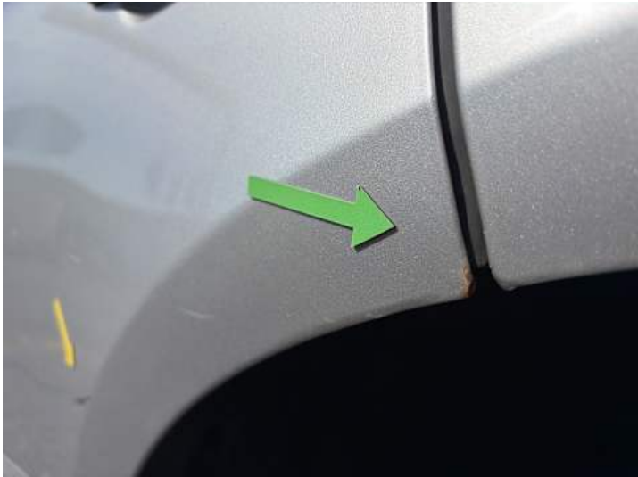
Türe hinten links (Rost, Kratzer, Delle)
