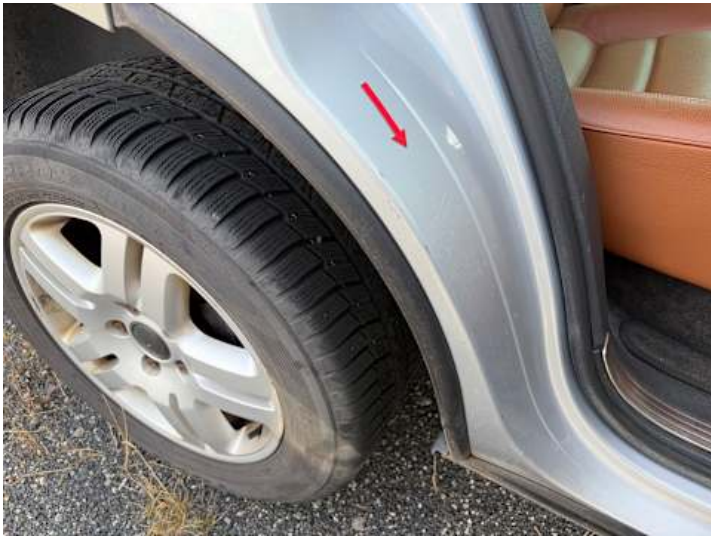
Türe hinten rechts (Kratzer, Verformung, Rost)
