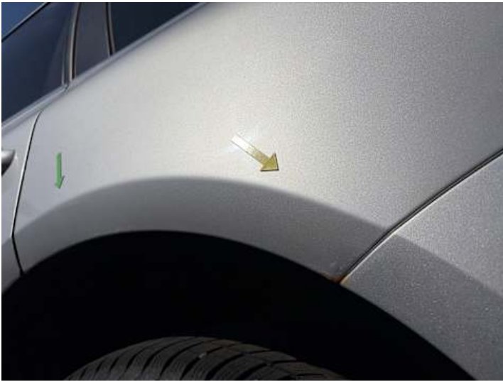
Seitenteil hinten links (Kratzer, Rost)
