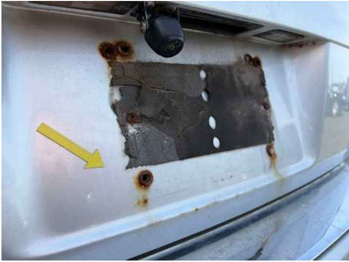
Heckklappe (Rost, Kratzer)
