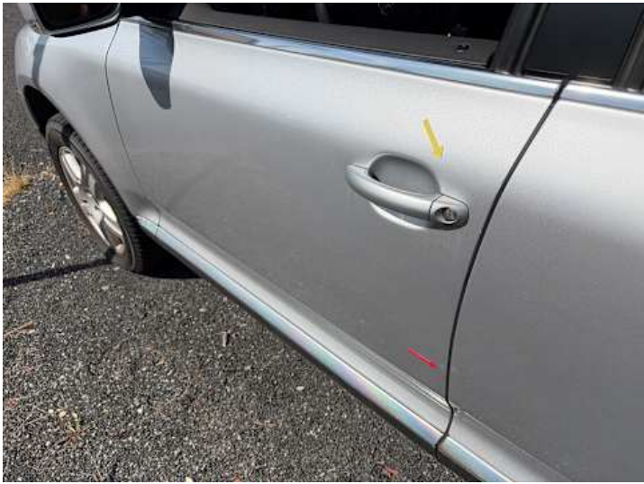
Fahrtür (Kratzer, Delle, Rost)
