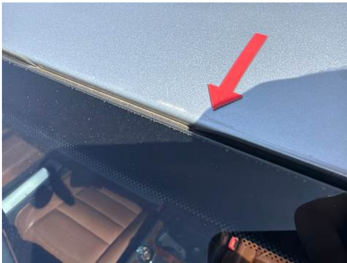
Dach (Kratzer, Rost)
