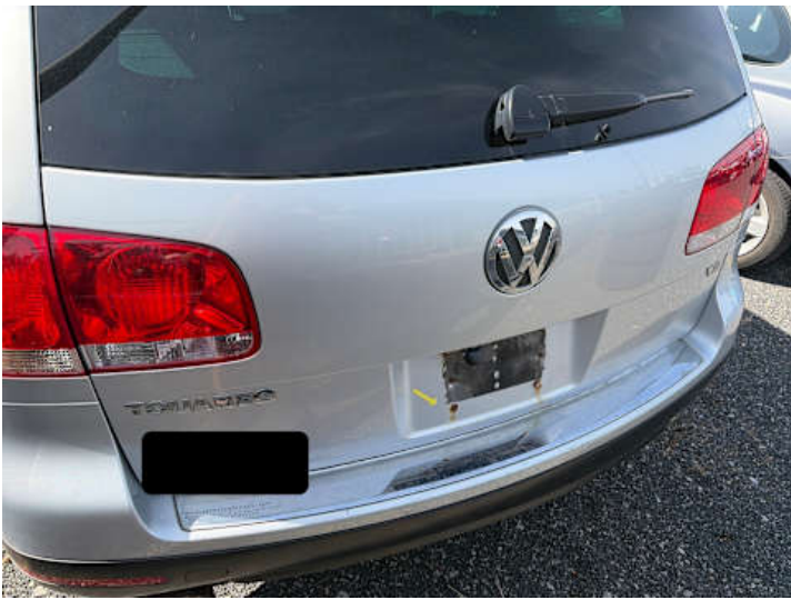
Heckklappe (Rost, Kratzer)
