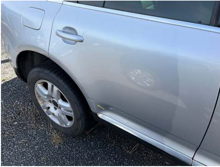
Türe hinten rechts (Kratzer, Verformung, Rost)
