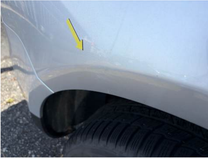
Seitenteil hinten rechts (Kratzer, Delle)
