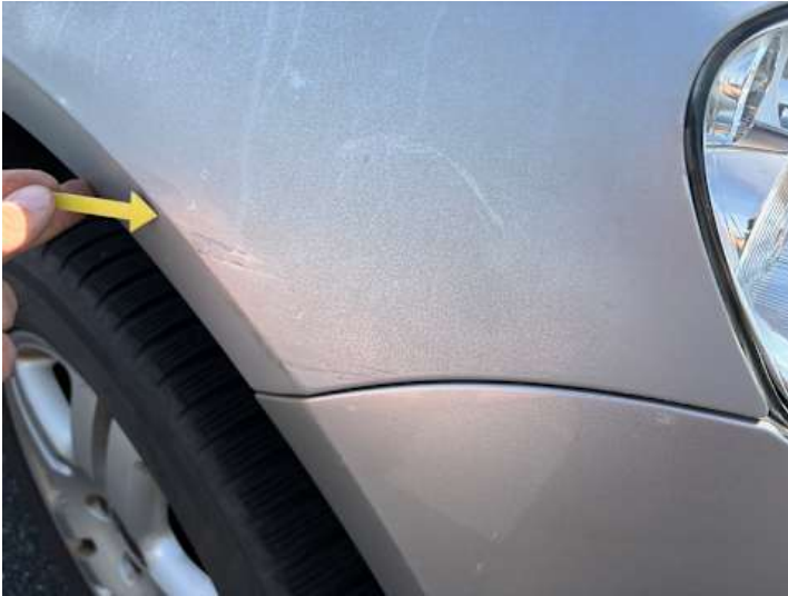
Kotflügel vorne rechts (Kratzer, Lackschaden)
