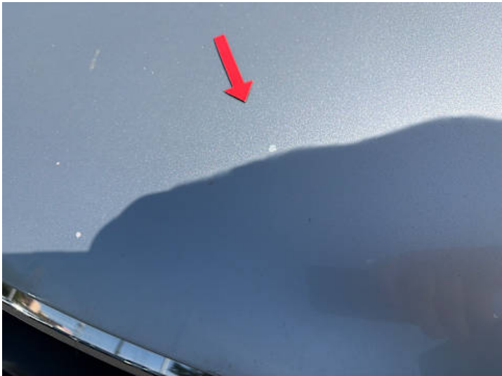
Motorhaube (Kratzer, Steinschlag)
