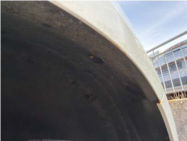
Seitenteil hinten links (Kratzer, Rost)
