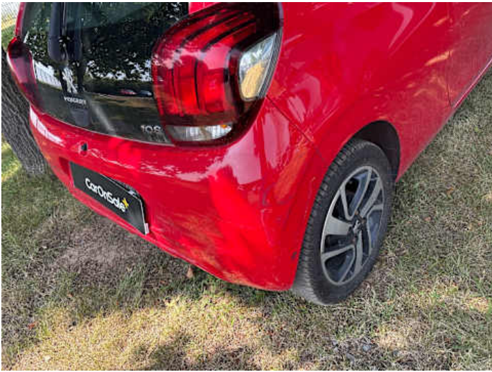
Stoßstange hinten (Spaltmaße ungenau, Kratzer)
