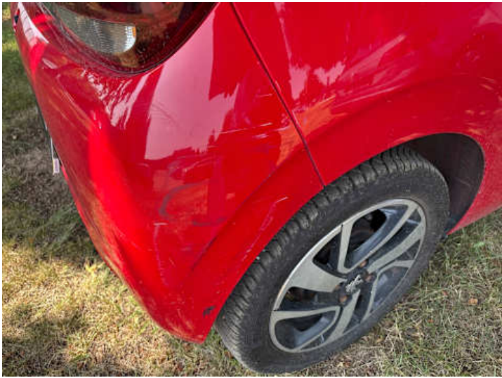
Stoßstange hinten (Spaltmaße ungenau, Kratzer)
