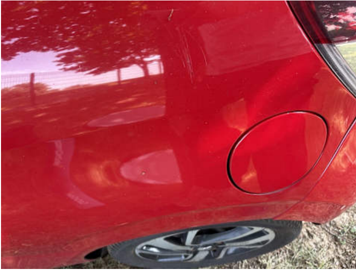
Seitenteil hinten links (Kratzer)
