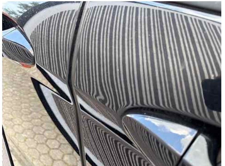
Beifahrtür (Delle, Kratzer)
