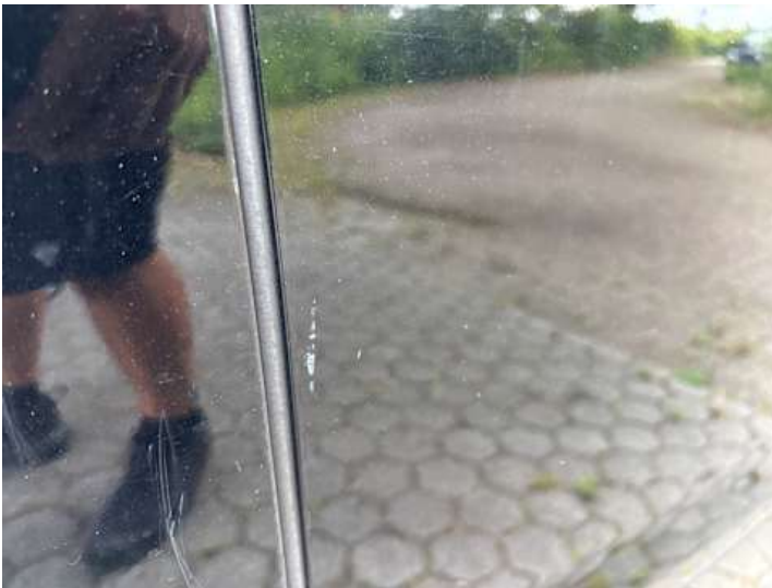
Beifahrtür (Delle, Kratzer)
