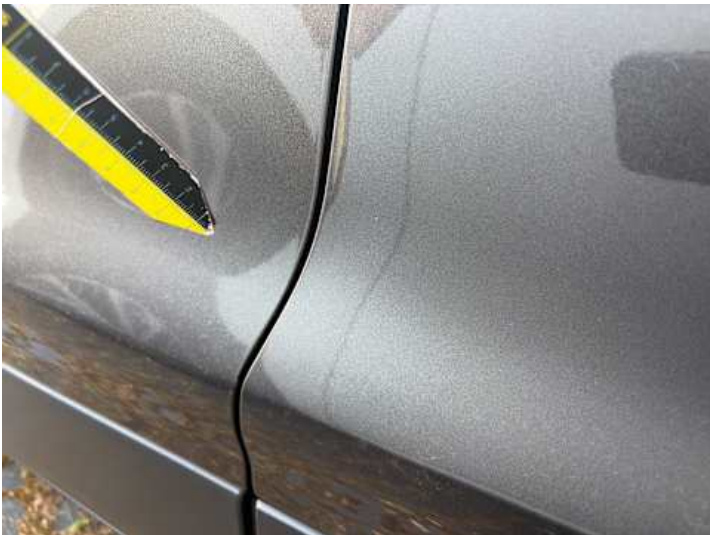
Fahrtür (Lackschaden, Kratzer)
