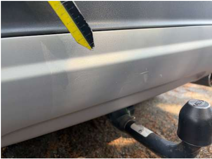
Stoßstange hinten (Lackschaden, Kratzer)
