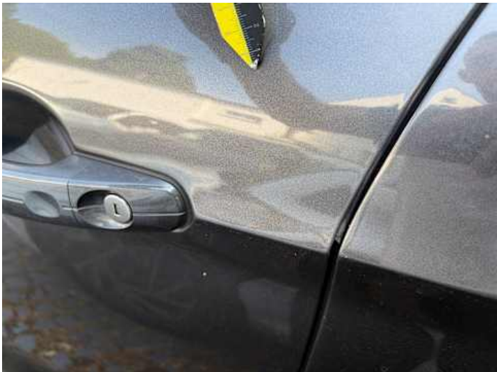
Fahrtür (Lackschaden, Kratzer)
