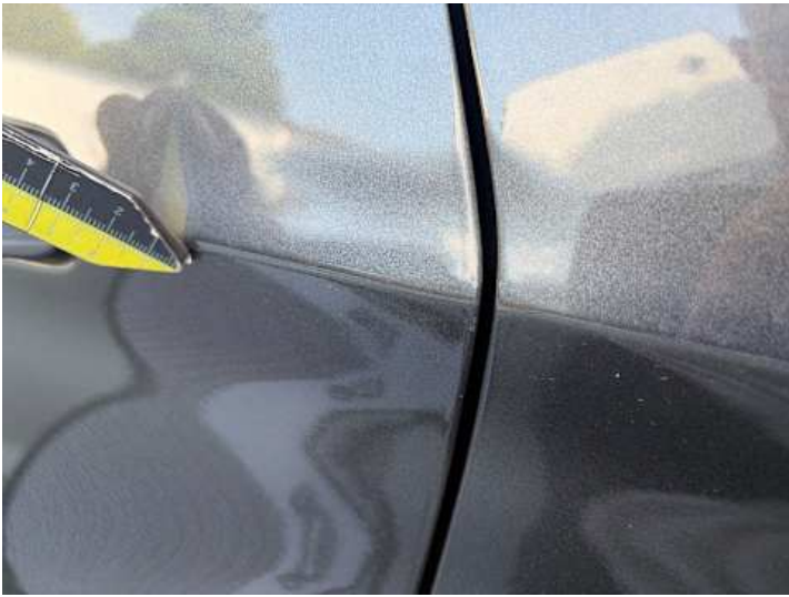
Türe hinten links (Lackschaden, Kratzer)
