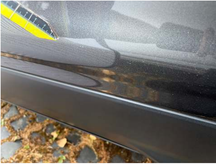
Türe hinten links (Lackschaden, Kratzer)
