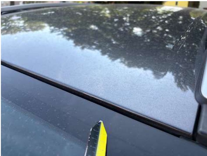
Dach (Lackschaden, Steinschlag)
