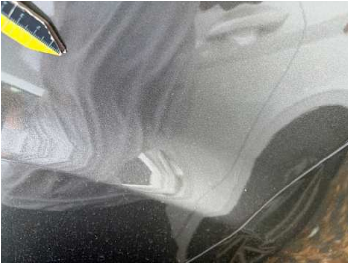
Seitenteil hinten links (Lackschaden, Kratzer)
