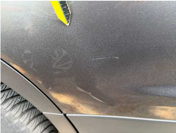
Türe hinten rechts (Lackschaden, Kratzer)
