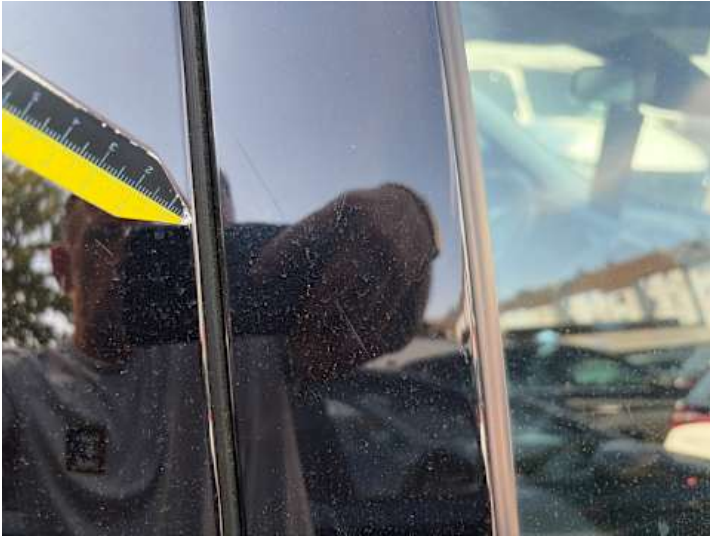
Beifahrertür (Lackschaden, Kratzer)
