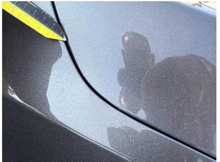
Motorhaube (Lackschaden, Steinschlag)
