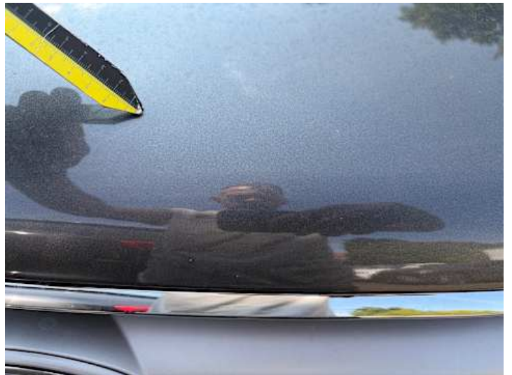
Motorhaube (Lackschaden, Steinschlag)
