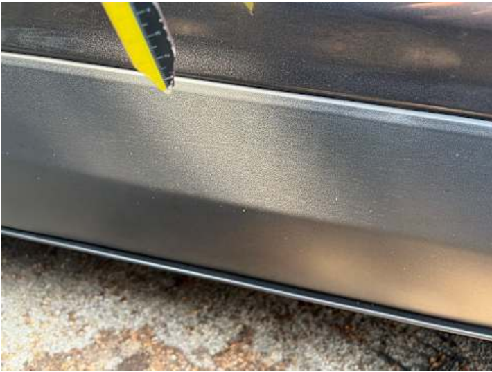
Beifahrertür (Lackschaden, Kratzer)
