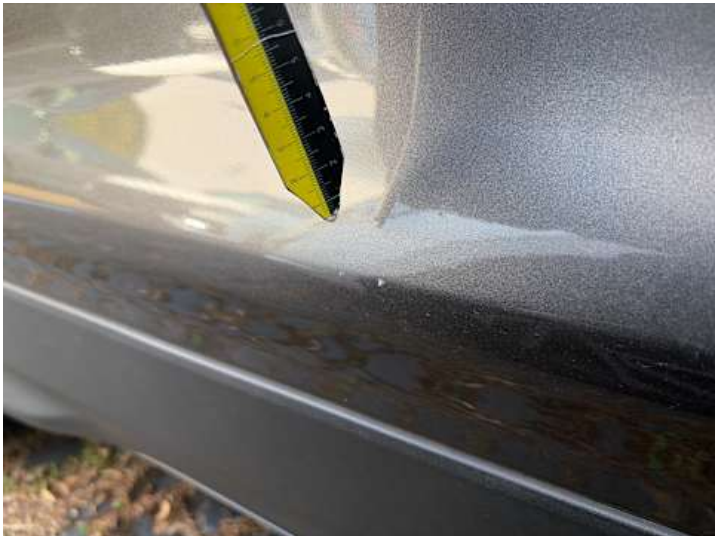
Fahrtür (Lackschaden, Kratzer)
