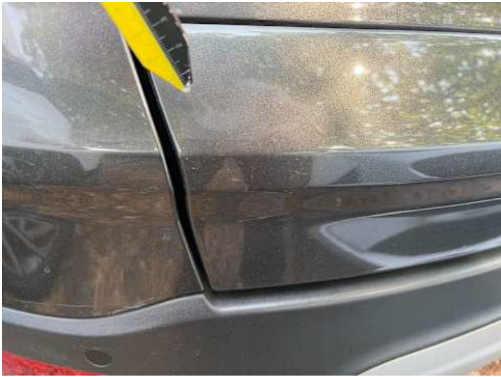
Heckklappe (Lackschaden, Kratzer)
