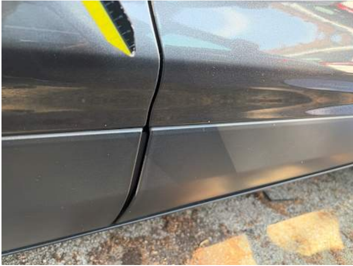
Beifahrertür (Lackschaden, Kratzer)
