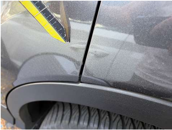
Türe hinten links (Lackschaden, Kratzer)
