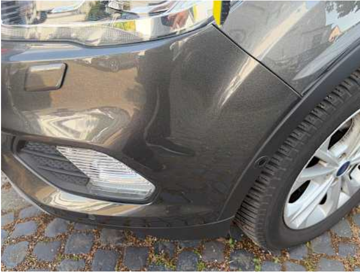
Stoßstange vorne (Anderer Schaden): Farbunterschied
