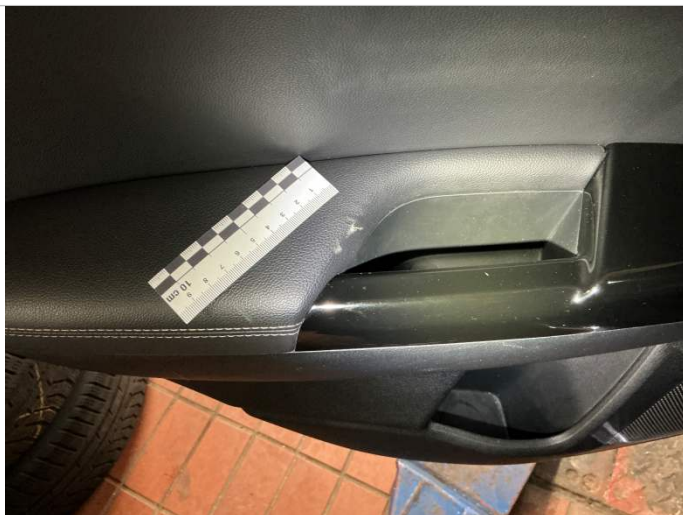
Türverkleidung hinten links Armlehne beschädigt.
