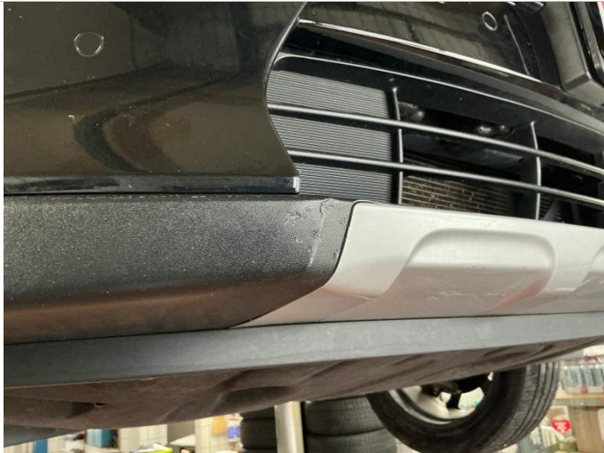
Stoßfängerschürze vorn Kratzer.
