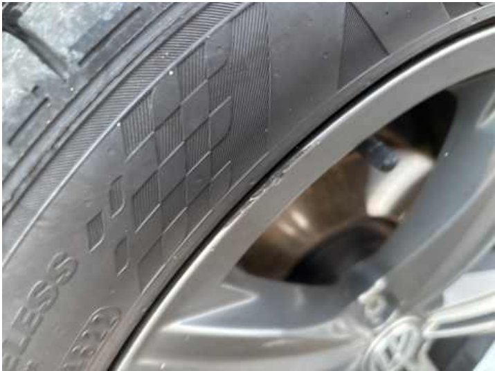
Rad (Kratzer, Kerben, Rost)
