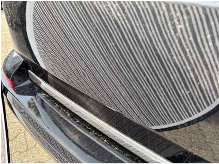
Heckklappe (Delle, Kratzer)
