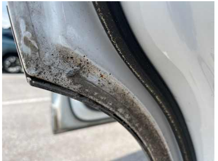
Türe hinten links (Rost)
