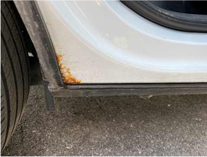
Schweller rechts (Rost)
