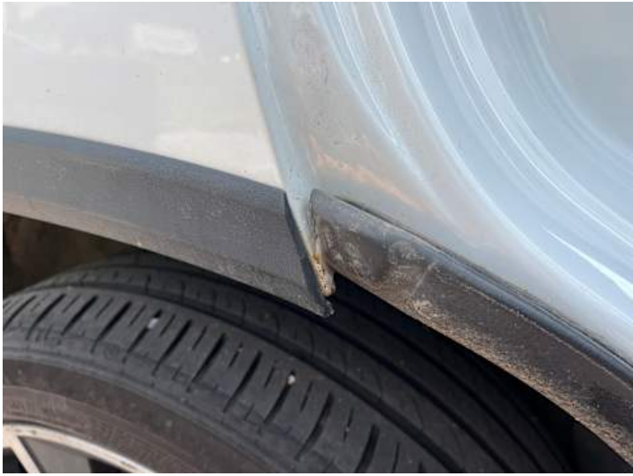
Seitenteil hinten rechts (Rost)
