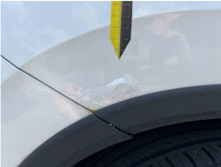
Seitenteil hinten rechts (Rost)
