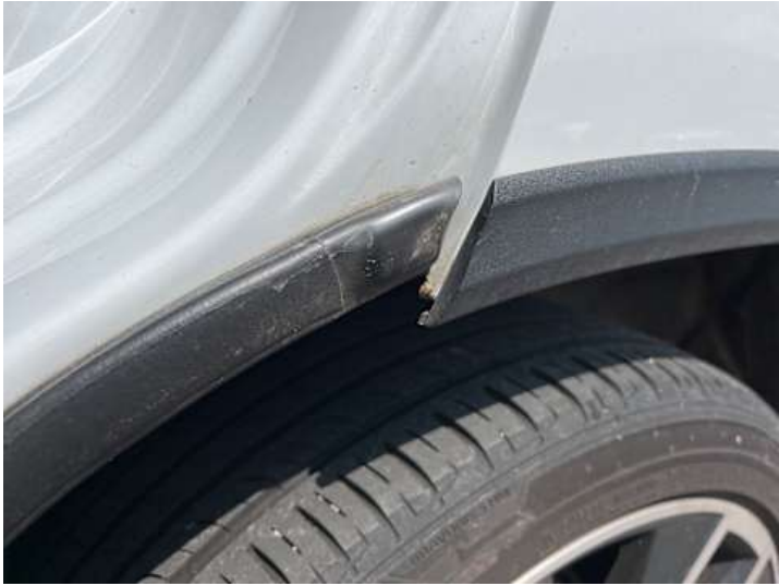
Seitenteil hinten links (Rost)
