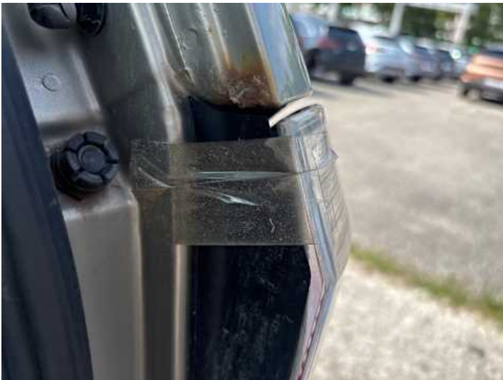
Rücklicht (rechts) (Anderer Schaden, Riss/Bruch): Halterung gebrochen
