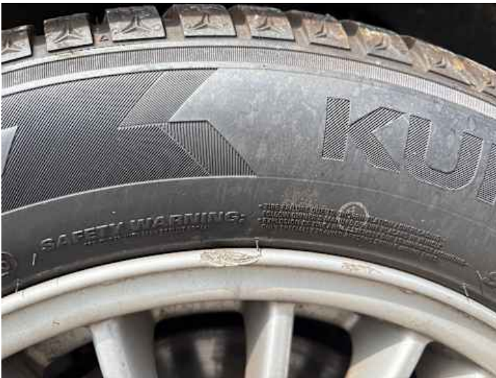
Rad (Kerben, Kratzer, Riss/Bruch)
