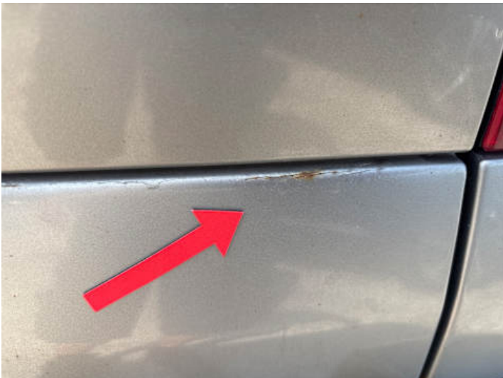
Heckklappe (Lackschaden, Rost, Kratzer)
