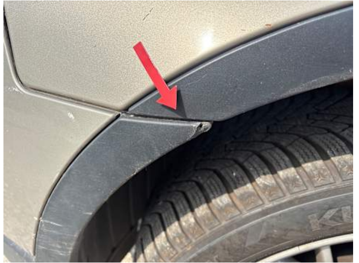
Stoßstange vorne (Riss/Bruch)
