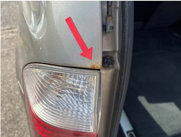
Seitenteil hinten links (Lackschaden, Rost)
