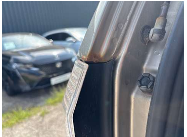
Seitenteil hinten links (Lackschaden, Rost)
