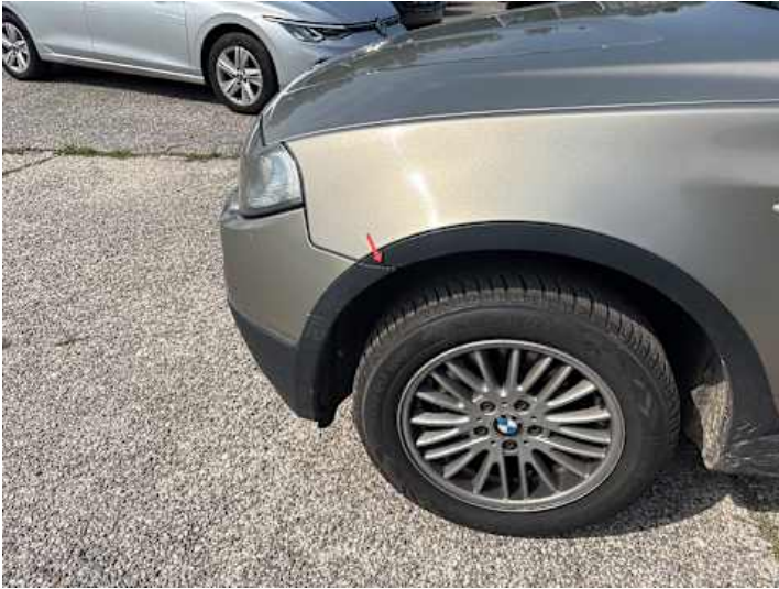
Stoßstange vorne (Riss/Bruch)
