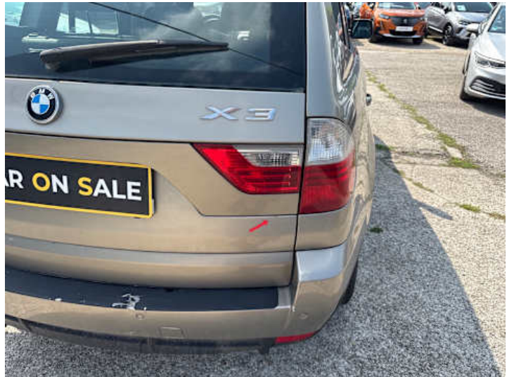
Heckklappe (Lackschaden, Rost, Kratzer)
