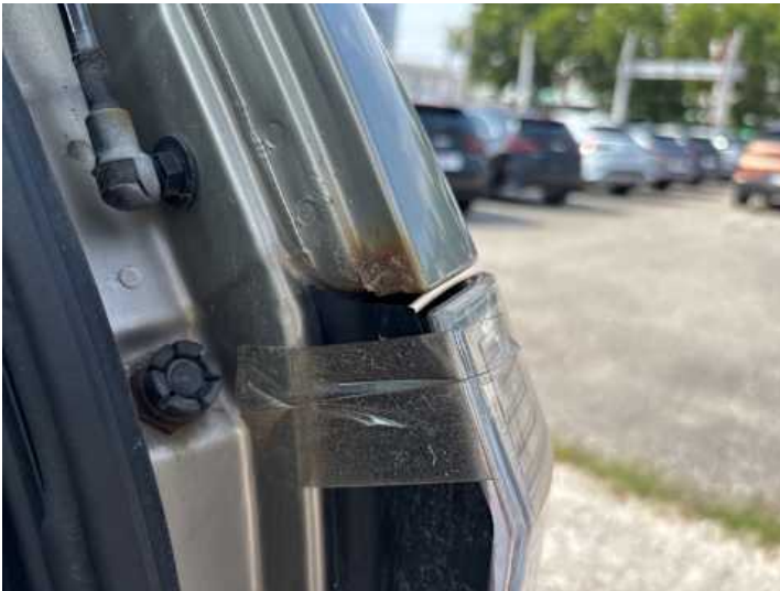
Seitenteil hinten rechts (Lackschaden, Rost)
