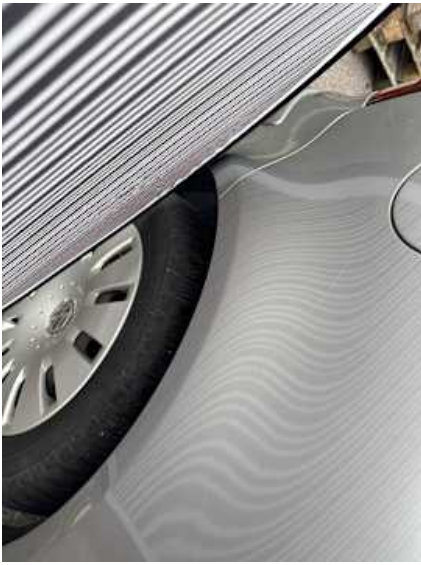
Seitenteil hinten rechts (Delle)
