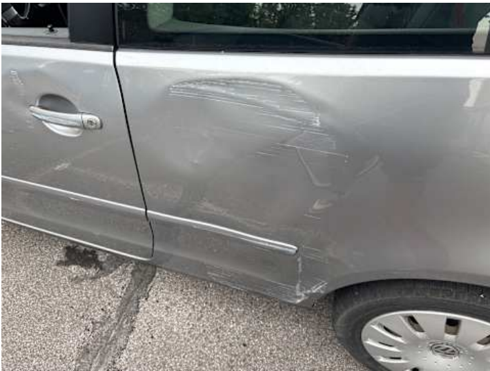
Seitenteil hinten links (Delle)
