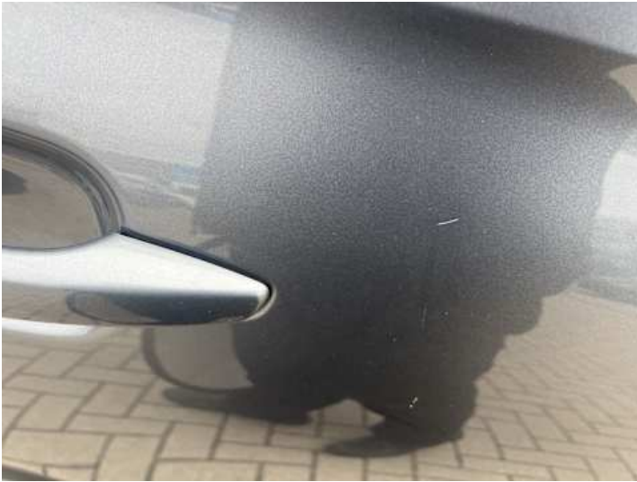
Türe hinten rechts (Kratzer, Lackschaden)
