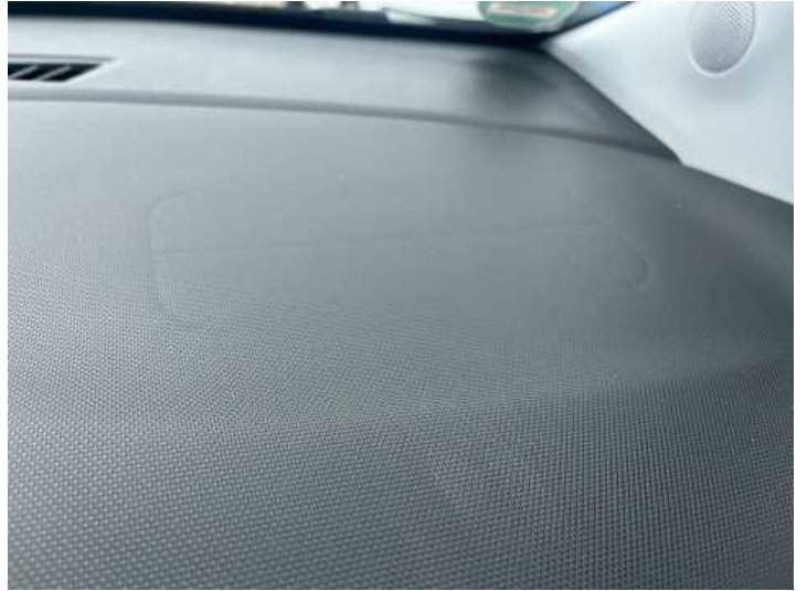
Innenraum (Anderer Schaden): Druckstelle
