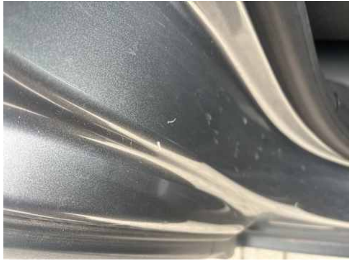
Türe hinten rechts (Kratzer, Lackschaden)
