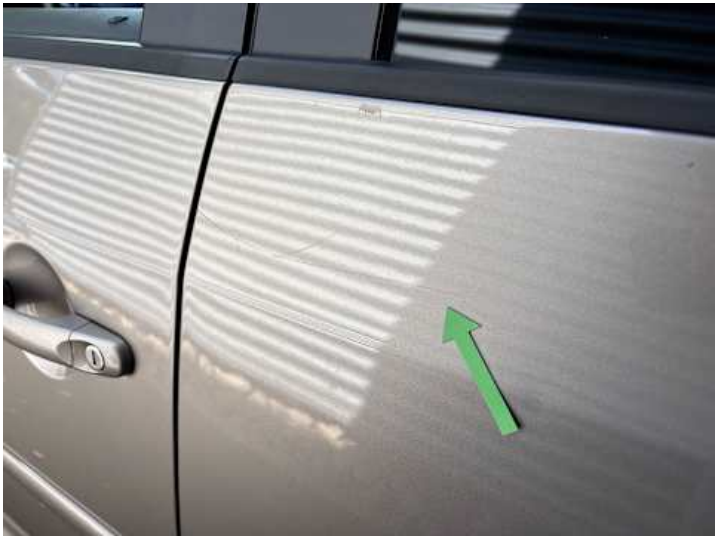
Türe hinten links (Lackschaden)
