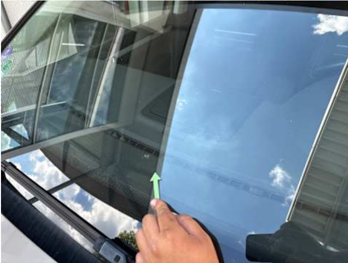
Windschutzscheibe (Steinschlag, Riss/Bruch)
