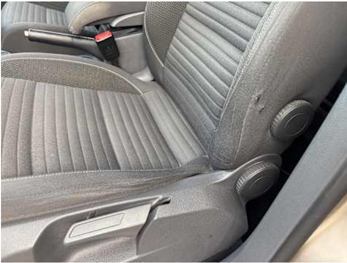
Innenraum (Riss/Bruch, Verschleiß)
