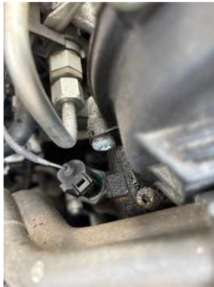
Motorhaube (Anderer Schaden): Ölverlust
