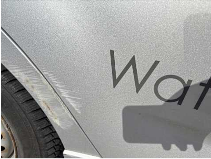
Türe hinten rechts (Delle, Verformung)
