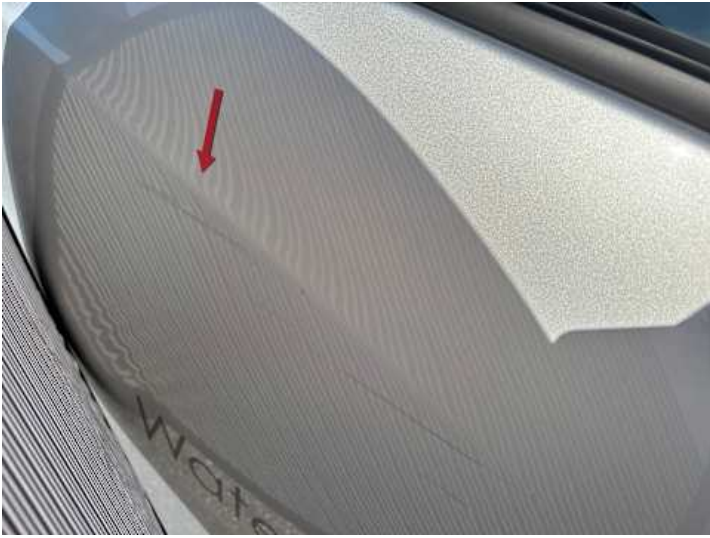
Türe hinten rechts (Delle, Verformung)
