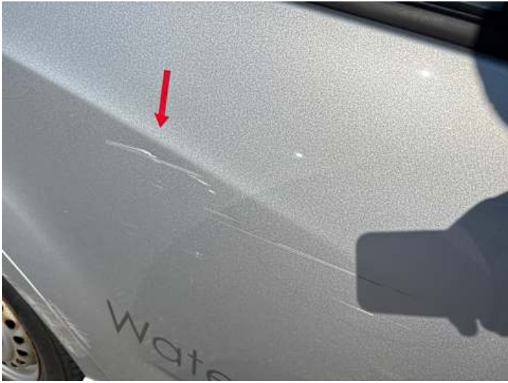
Türe hinten rechts (Delle, Verformung)
