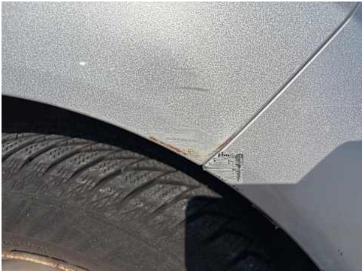
Kotflügel vorne rechts (Kratzer, Rost)
