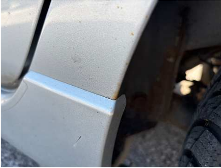
Seitenteil hinten links (Rost)
