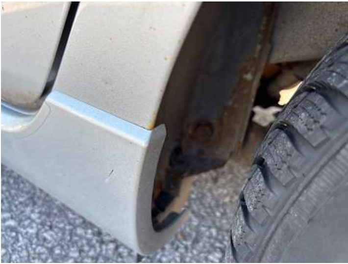
Schweller links (Rost)
