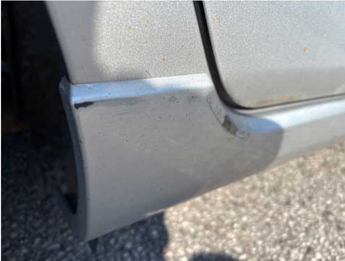
Schweller rechts (Kratzer)
