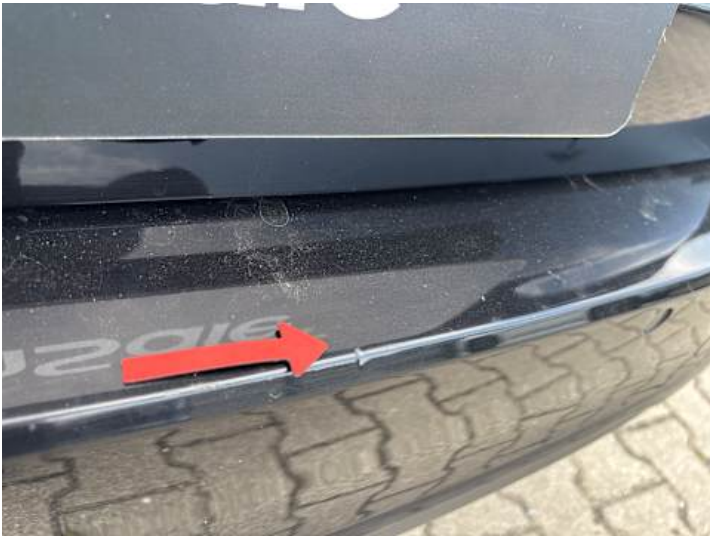
Stoßstange hinten (Kratzer)
