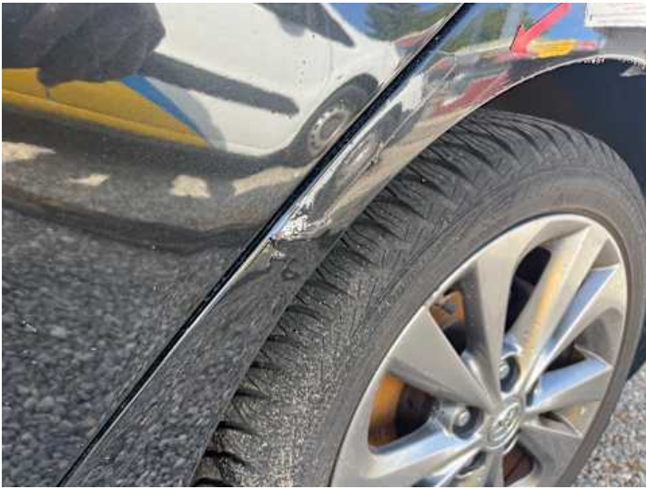
Seitenteil hinten links (Rost, Unsachgemäß instand gesetzt)
