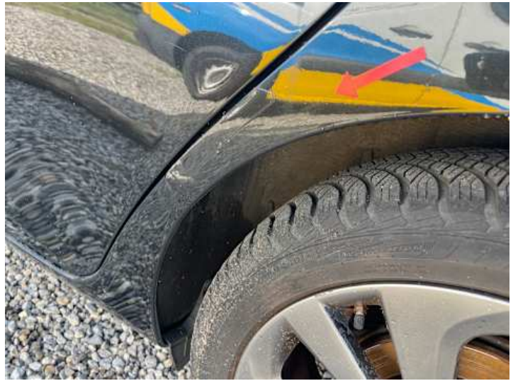
Seitenteil hinten links (Rost, Unsachgemäß instand gesetzt)
