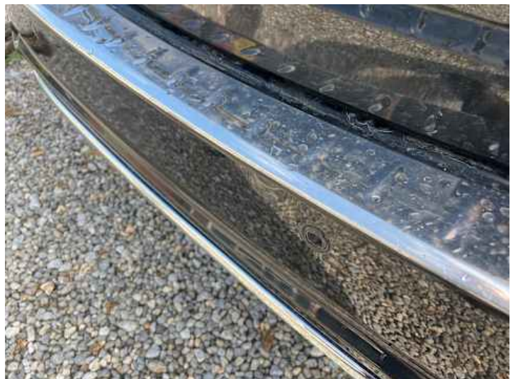
Stoßstange hinten (Kratzer, Verformung)
