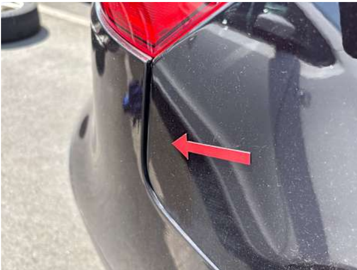
Seitenteil hinten rechts (Spaltmaße ungenau)
