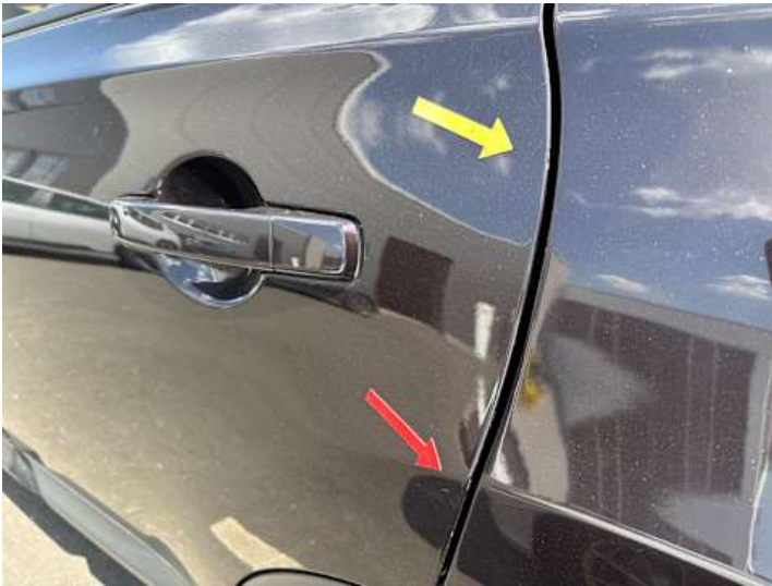
Seitenteil hinten links (Lackschaden)
