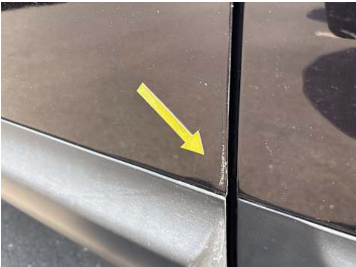
Fahrtür (Lackschaden, Kratzer)
