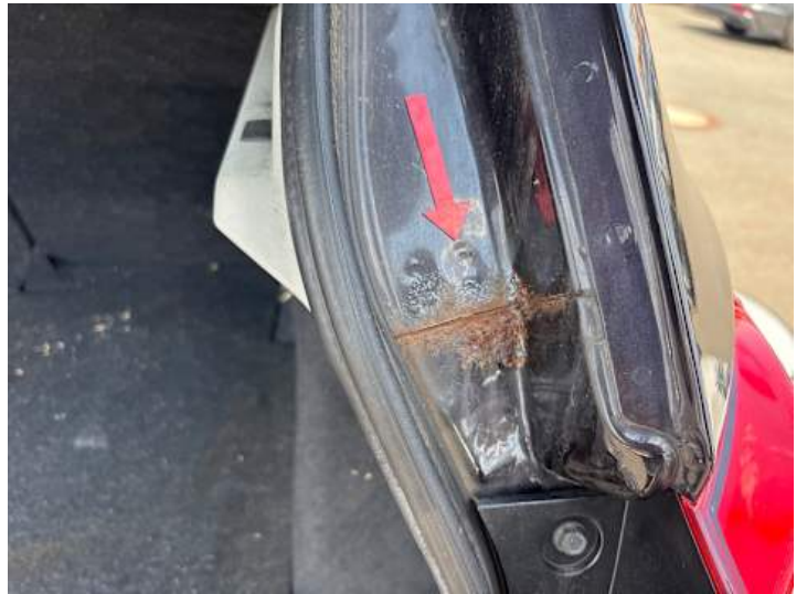
Seitenteil hinten rechts (Rost)
