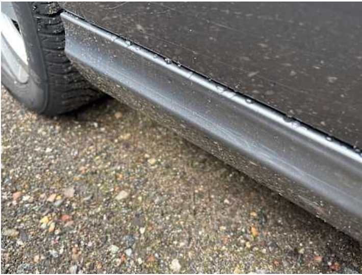
Schweller rechts (Kratzer)
