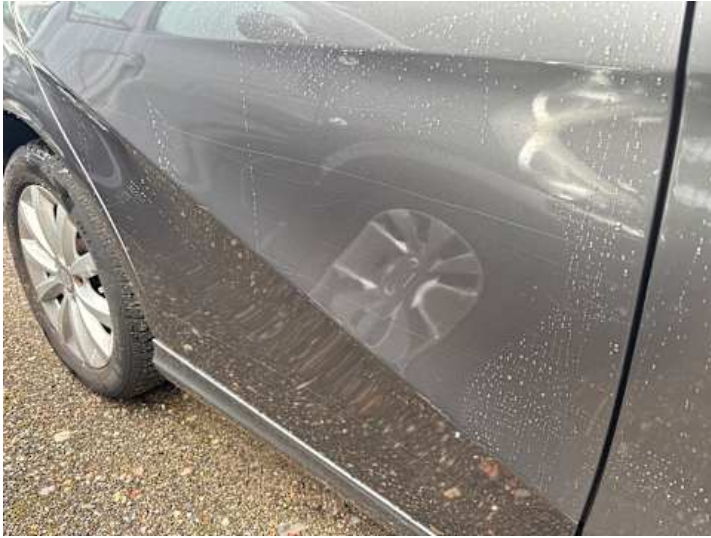
Türe hinten rechts (Kratzer, Lackschaden)
