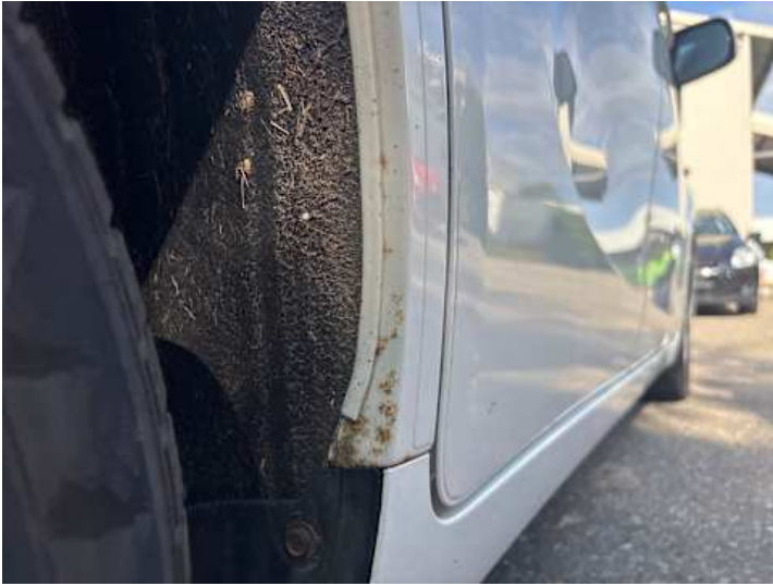
Seitenteil hinten rechts (Rost)
