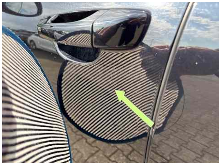
Fahrtür (Delle, Kratzer)
