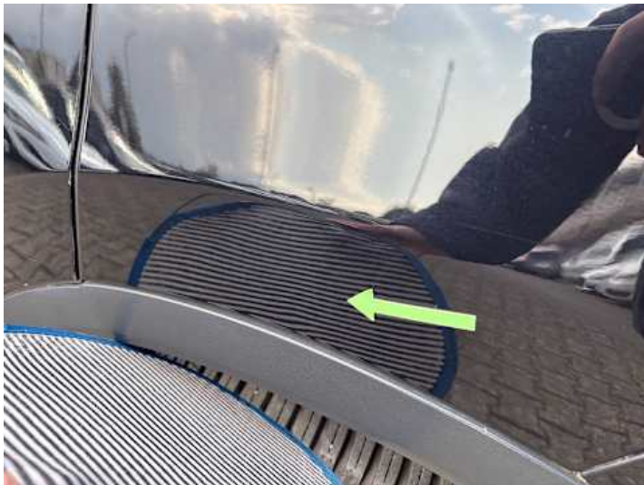
Seitenteil hinten links (Delle)
