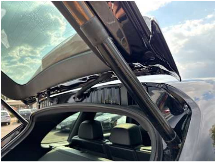
Heckklappe (Anderer Schaden): Elektrische Dämpfer auf Störung, öffnet und schließt fehlerhaft.
