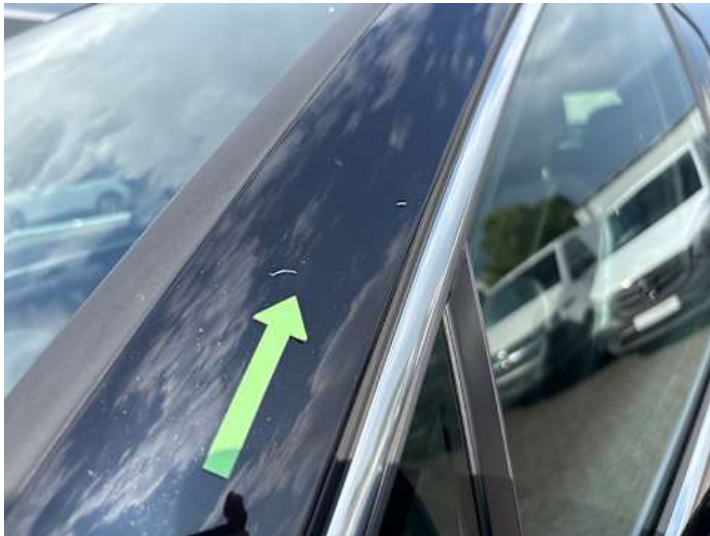
Fahrtür (Delle, Kratzer)
