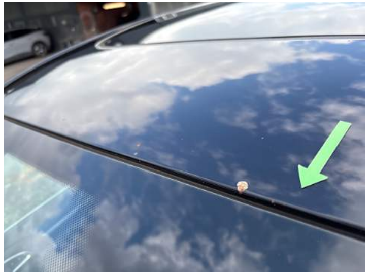
Dach (Steinschlag, Rost)
