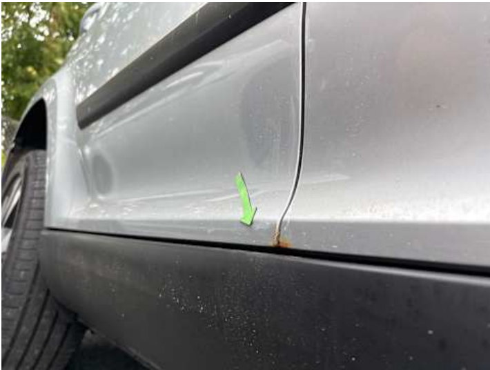
Türe hinten rechts (Rost)
