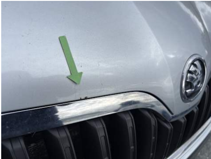
Motorhaube (Rost, Steinschlag)
