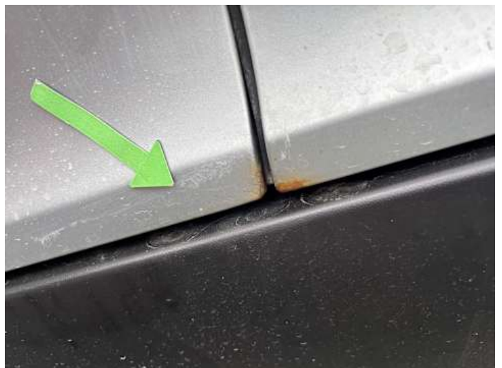
Türe hinten rechts (Rost)
