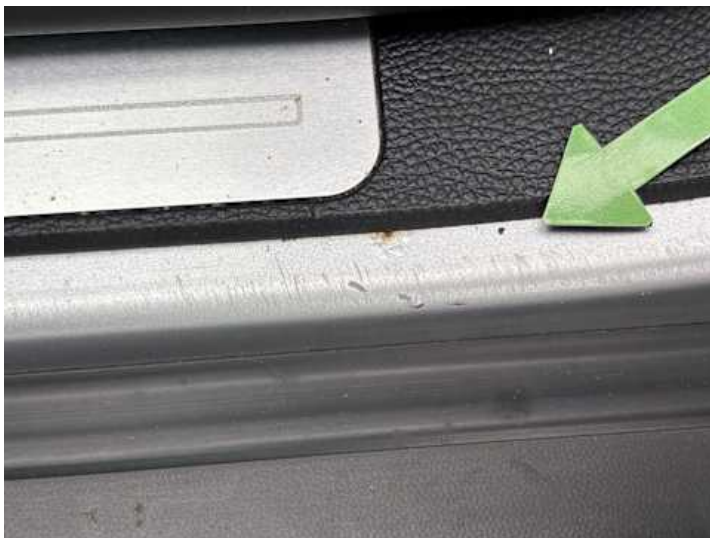
Fahrtür (Kratzer, Rost)
