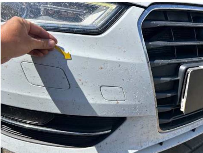
Stoßstange vorne (Lackschaden, Steinschlag)
