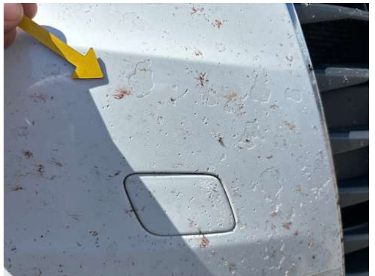
Stoßstange vorne (Lackschaden, Steinschlag)
