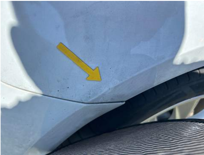
Seitenteil hinten rechts (Delle, Kratzer)
