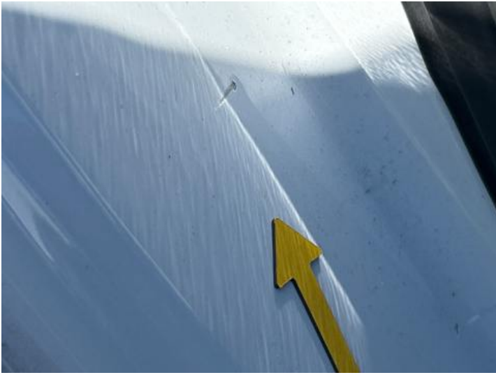
Seitenteil hinten rechts (Kratzer)
